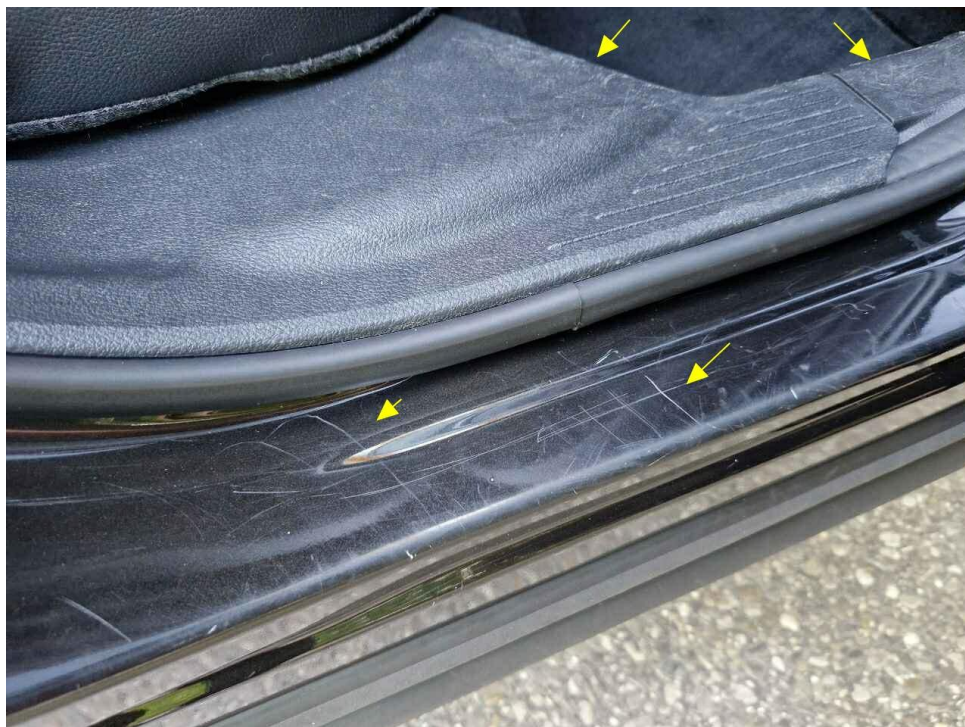
Bild 34 : Einstieg hinten rechts Kratzer
