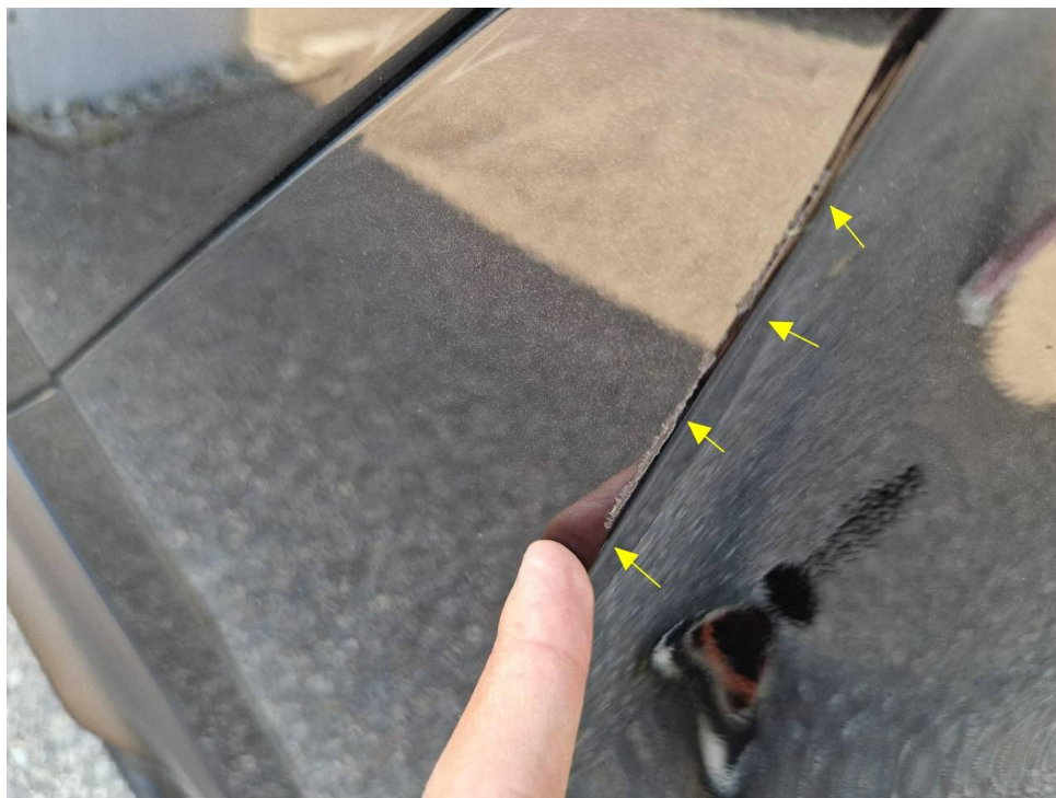
Bild 15 : Stoßfänger hinten Kratzer
