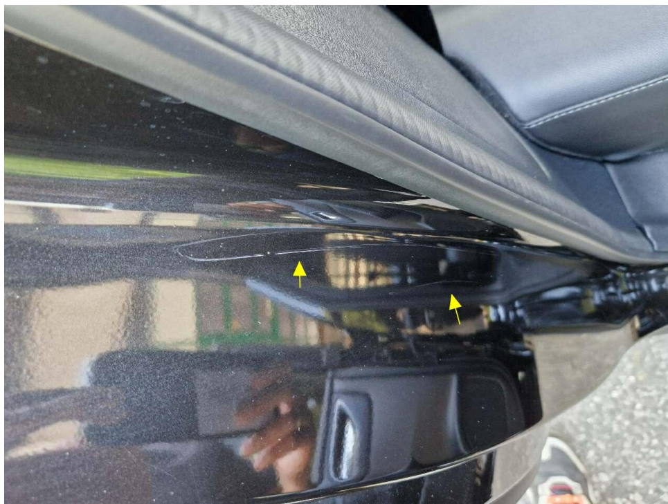
Bild 33 : Einstieg hinten rechts Kratzer
