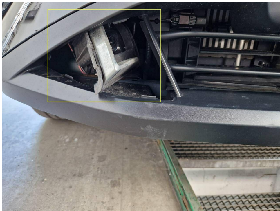
Bild 27 : Nebelscheinwerfer rechts ausgerissen
