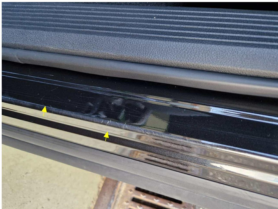
Bild 30 : Einstieg vorn links Kratzer
