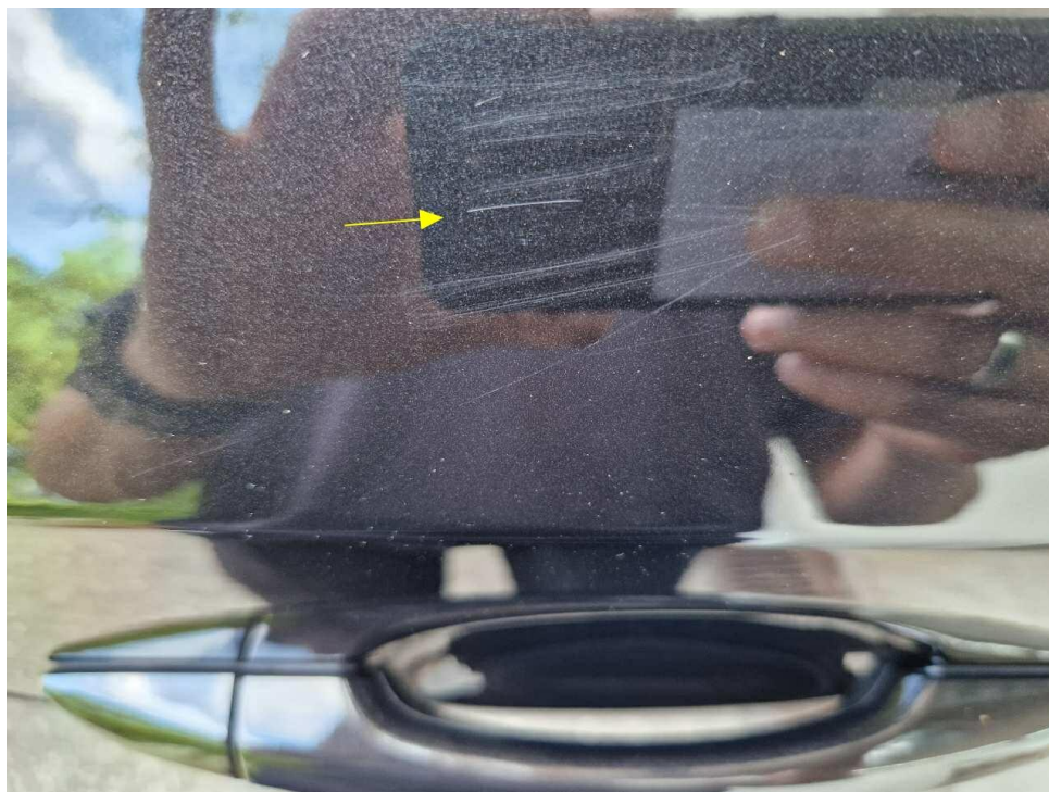
Bild 39 : Tür vorn rechts Kratzer
