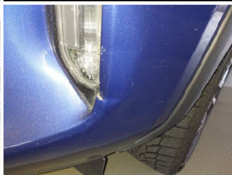
Stoßfänger / Vorne / Gebrochen
