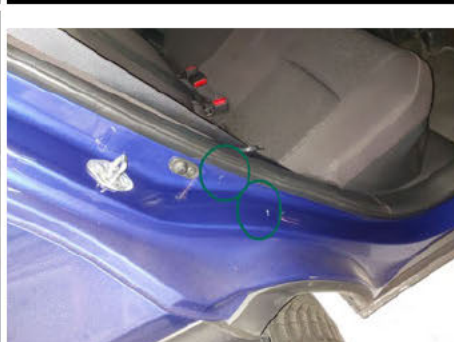
Türeinstieg / Hinten Rechts / Kratzer
