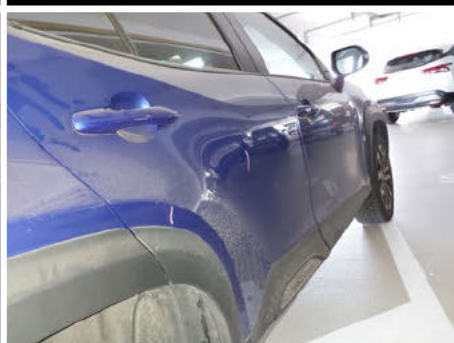
Tür / Hinten Rechts / Delle
