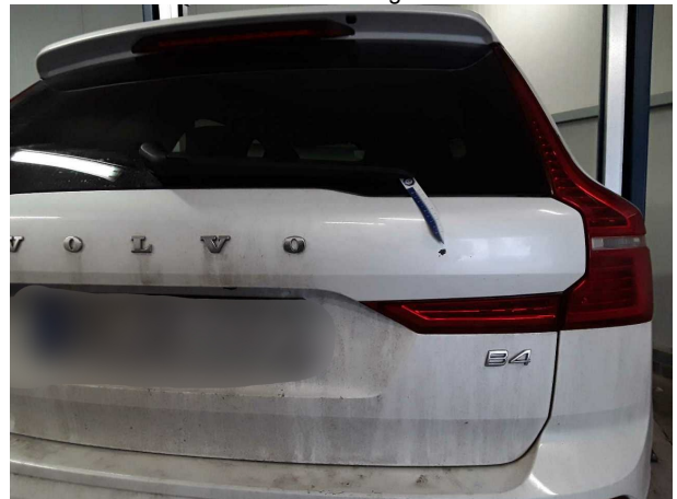
Beschädigung #5: Heckklappe/-tür: Heckklappe - Lackmangel - lackieren
