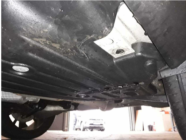
Beschädigung #1: Schweller links: Wagenheberaufnahme hinten - fehlt - erneuern
