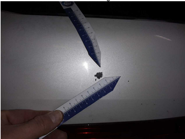
Beschädigung #5: Heckklappe/-tür: Heckklappe - Lackmangel - lackieren
