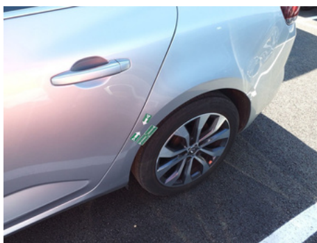
Aile / Arrière Gauche / Enfoncement
