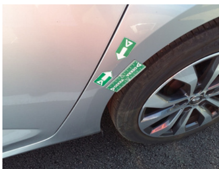
Aile / Arrière Gauche / Enfoncement
