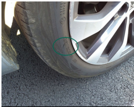
Pneu / Arrière Droit / Déchiré
