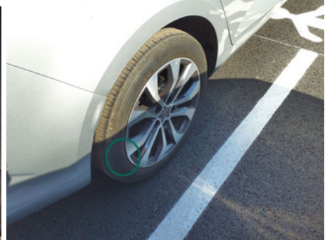
Pneu / Arrière Droit / Déchiré
