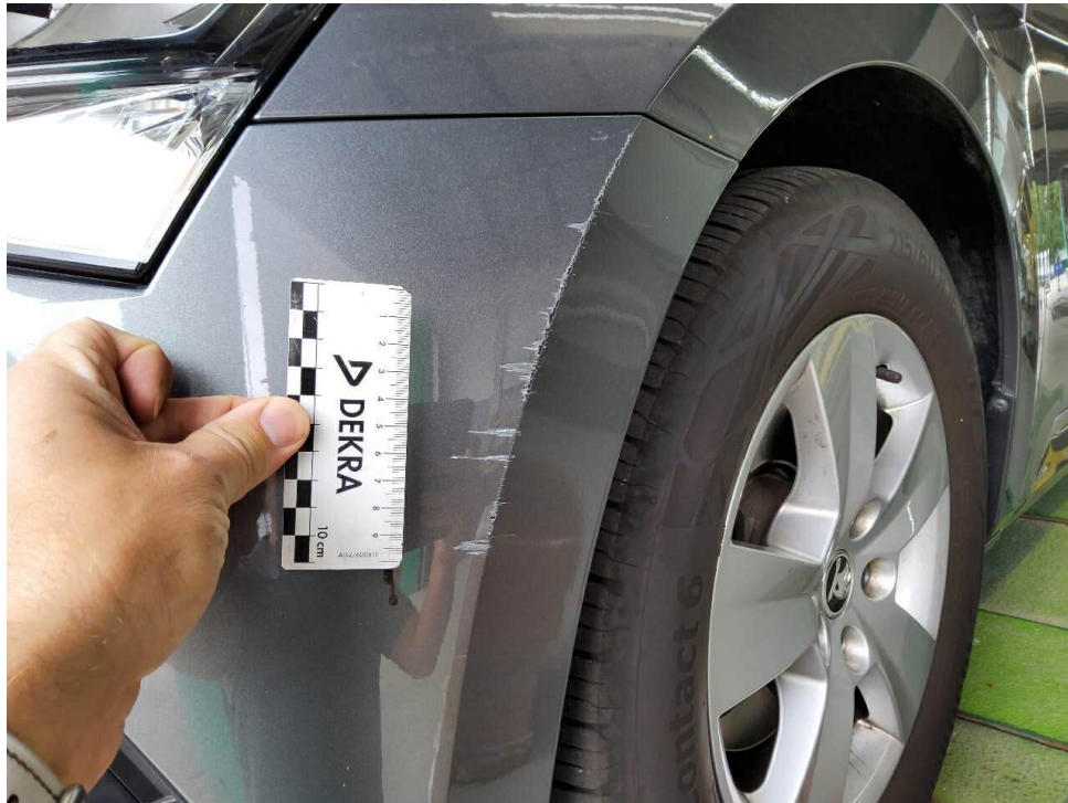
Bild 15 : Stoßfänger vorne Anstoßschaden (inkl. unterer Kühlergrill gebrochen)
