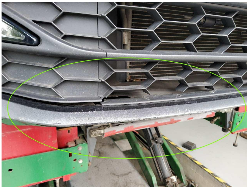
Bild 17 : Stoßfänger vorne Anstoßschaden (inkl. unterer Kühlergrill gebrochen)
