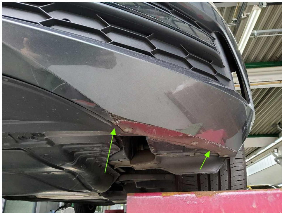
Bild 19 : Stoßfänger vorne Anstoßschaden (inkl. unterer Kühlergrill gebrochen)
