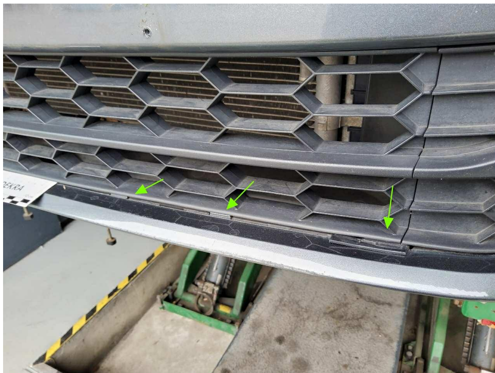
Bild 18 : Stoßfänger vorne Anstoßschaden (inkl. unterer Kühlergrill gebrochen)
