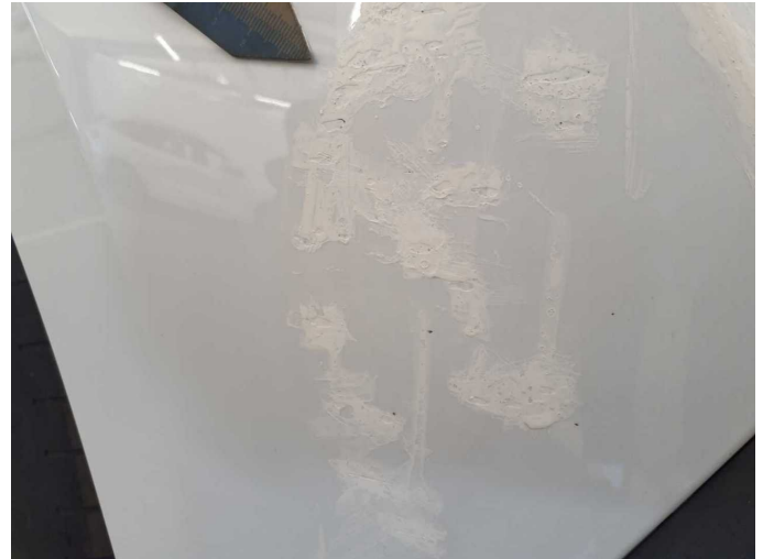
Damage 1: Front bumper: Front bumper (im Unfall Kalk. erhalten) - Scratch(es) - Paint
