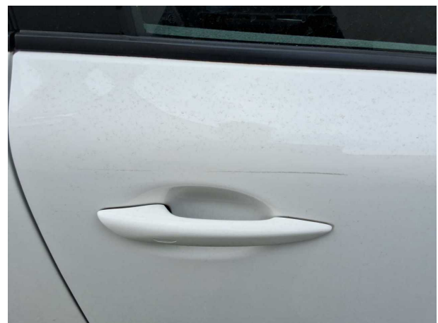
Beschädigung #7: Tür vorn rechts: Tür - Kratzer - lackieren
