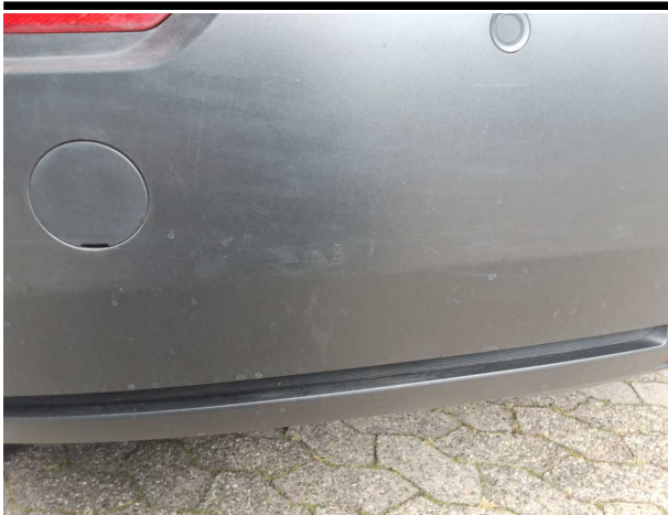
Beschädigung #6: Stossfänger hinten: Stossfänger hinten - beschädigt - lackieren
