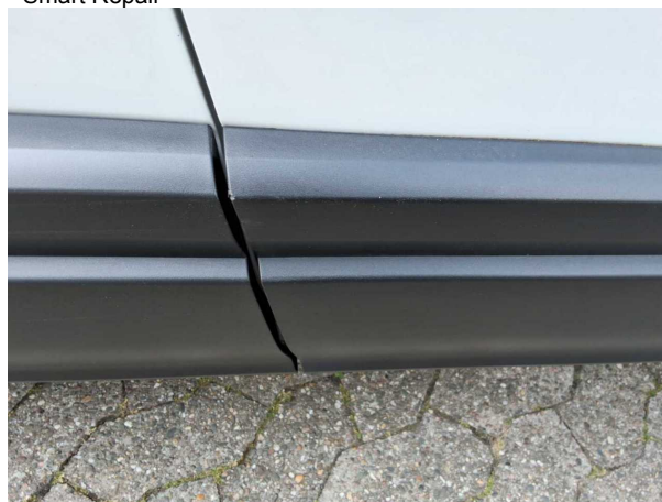
Beschädigung #3: Tür vorn rechts: Zierleiste unten - beschädigt - erneuern
