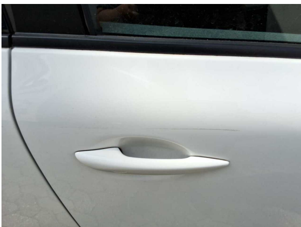
Beschädigung #7: Tür vorn rechts: Tür - Kratzer - lackieren
