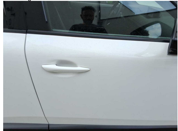
Beschädigung #7: Tür vorn rechts: Tür - Kratzer - lackieren
