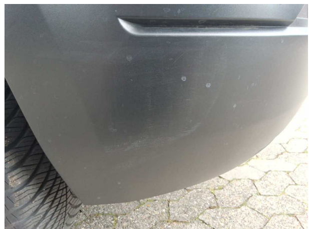
Beschädigung #6: Stossfänger hinten: Stossfänger hinten - beschädigt - lackieren
