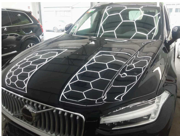
Beschädigung #7: Motorhaube: Motorhaube - Lackmangel - instandsetzen und lackieren
