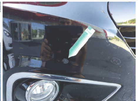
Stoßfänger / Vorne / Schlecht Repariert
