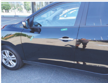
Tür / Vorne Links / Delle
