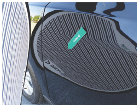
Tür / Vorne Links / Delle
