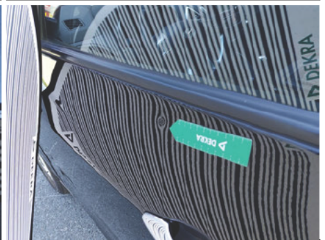
Tür / Vorne Links / Delle
