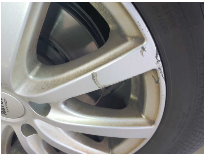
Wear and tear 2: Wheel / tyres: Alloy rim - front left side (Kein Teil der Ausstattung) - Scratch(es) - No deduction
