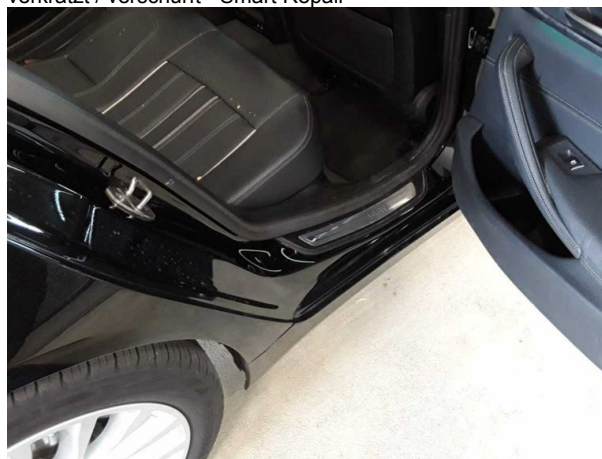
Beschädigung #7: Seitenwand rechts: Einstieg - Delle / Lackschaden - instandsetzen und lackieren
