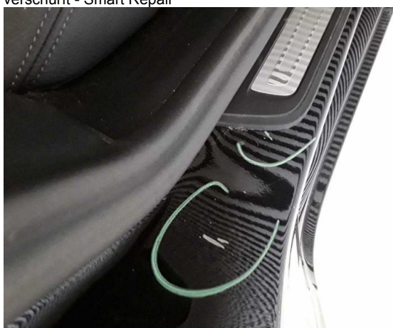
Beschädigung #7: Seitenwand rechts: Einstieg - Delle / Lackschaden - instandsetzen und lackieren
