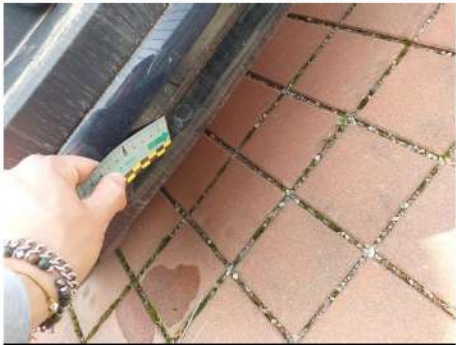
Parte inferiore paraurti / Posteriore / Rotto
