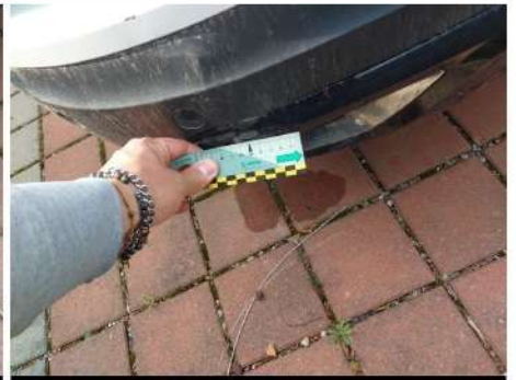
Parte inferiore paraurti / Posteriore / Rotto
