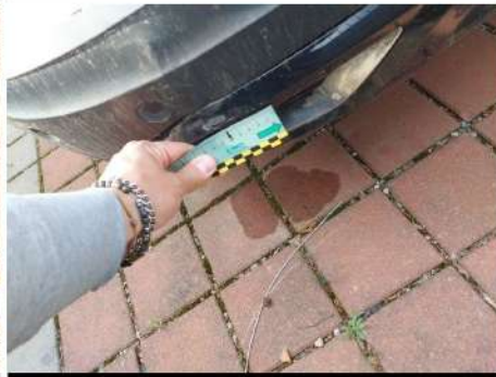
Parte inferiore paraurti / Posteriore / Rotto
