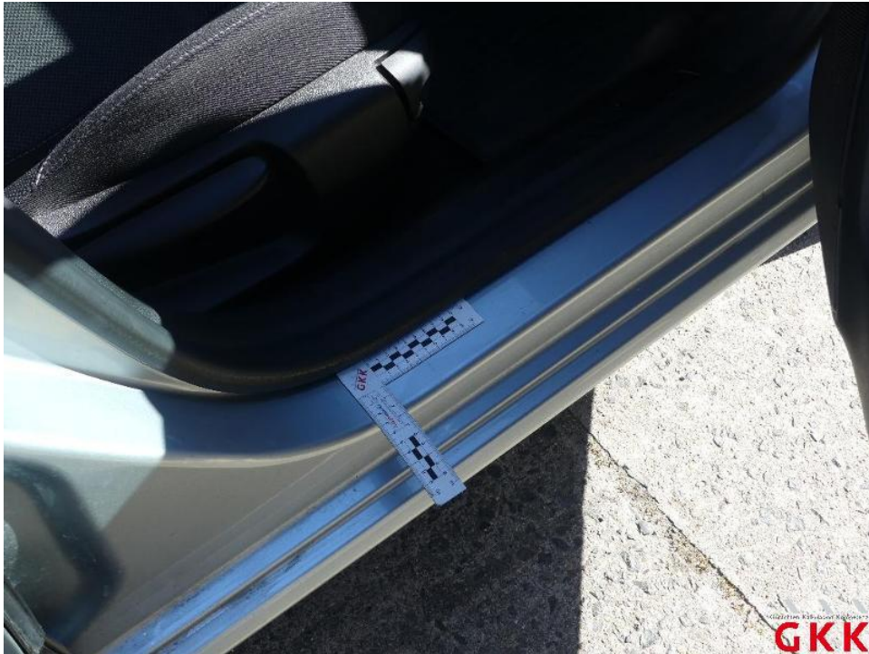
Bild 51. Tür vorne rechts, Einstieg, beschädigt, instand setzen - lackieren
