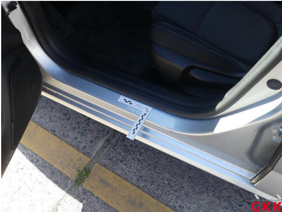
Bild 22. Tür vorne links, Einstieg, verkratzt, lackieren
