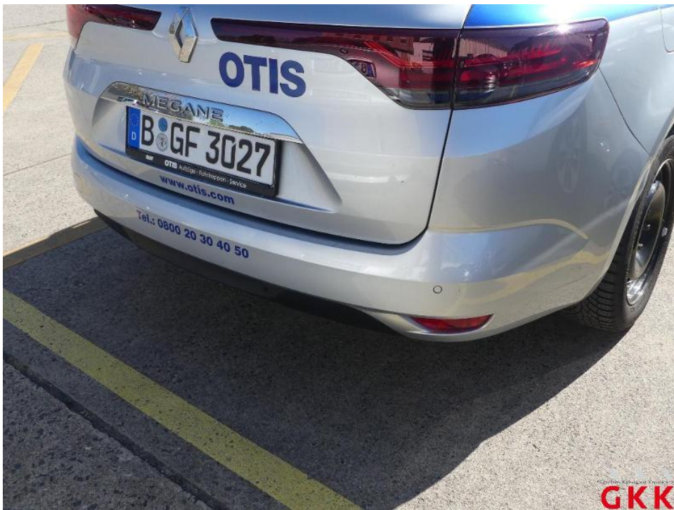
Bild 36. Stoßfänger hinten, Verkleidung -lackiert-, verkratzt, lackieren
