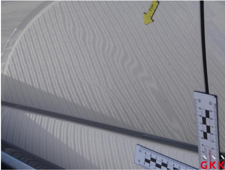
Bild 21. Tür vorne links, beschädigt, instand setzen - lackieren
