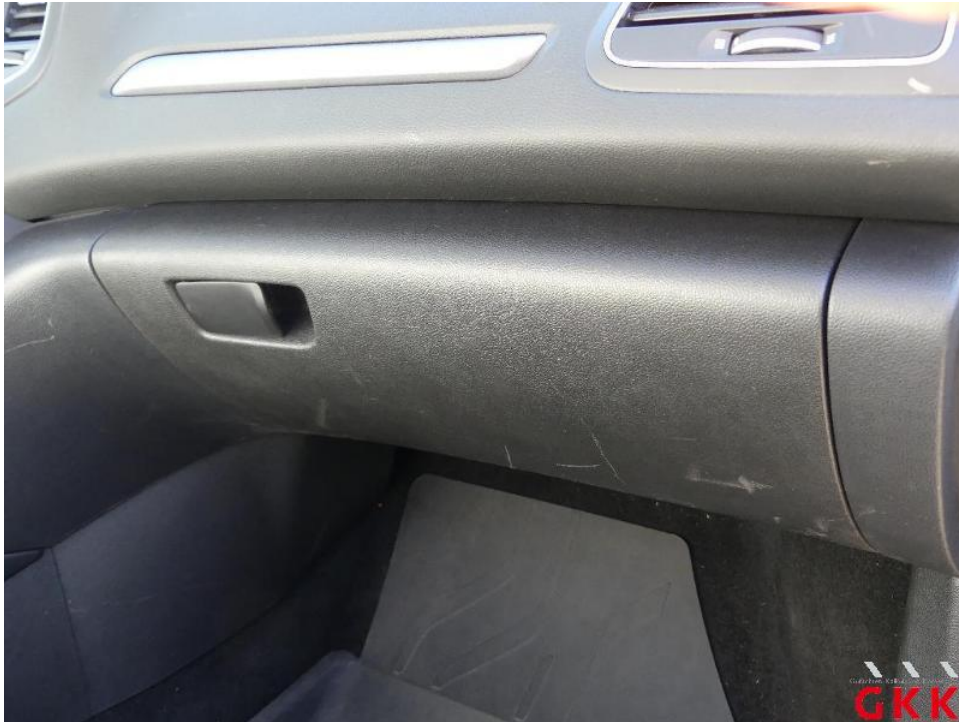
Bild 57. Handschuhfach, Deckel, verkratzt, ersetzen
