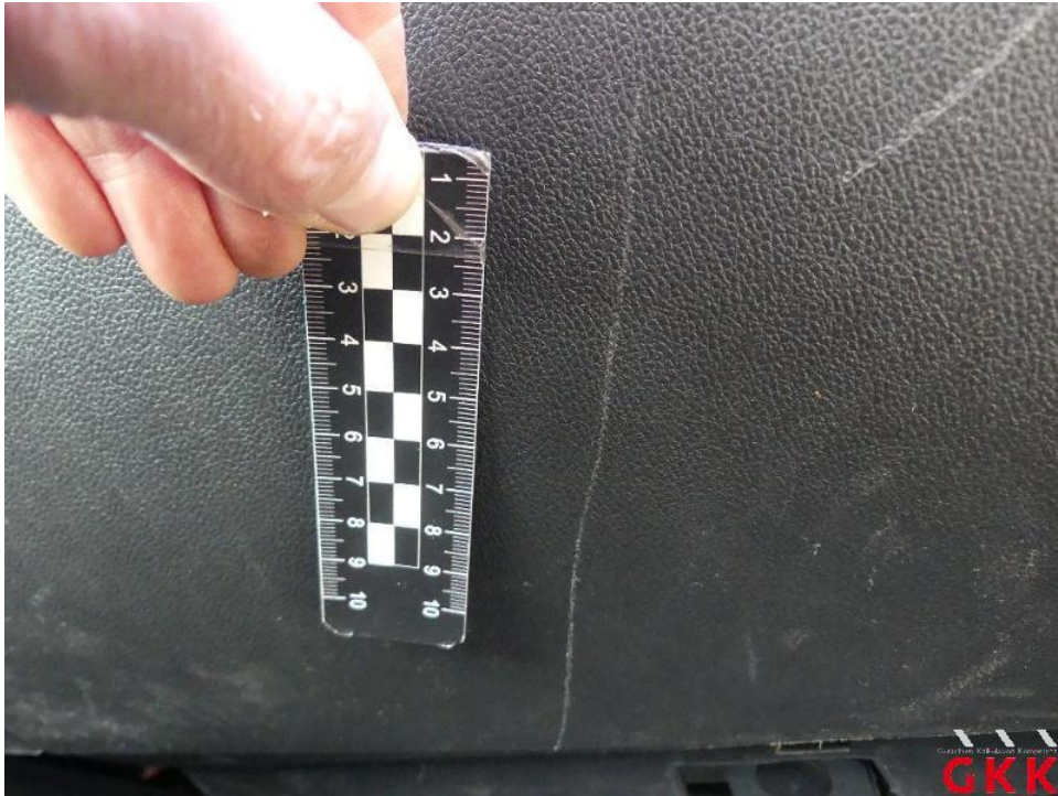
Bild 59. Handschuhfach, Deckel, verkratzt, ersetzen
