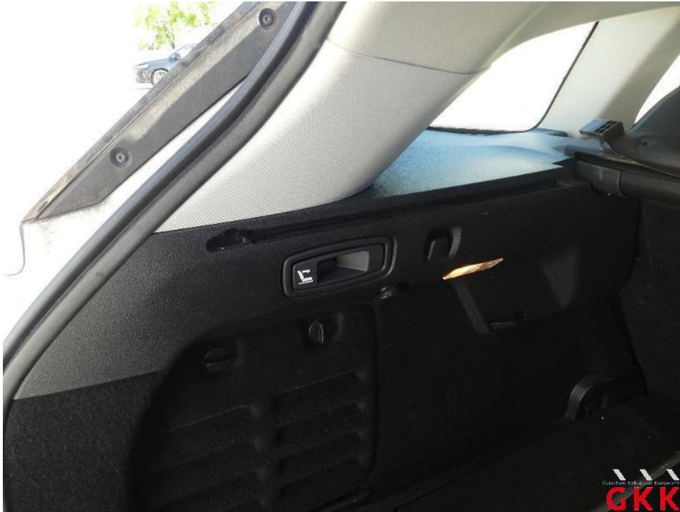
Bild 45. Seitenwand links, Innenverkleidung, verkratzt, Smartrepair
