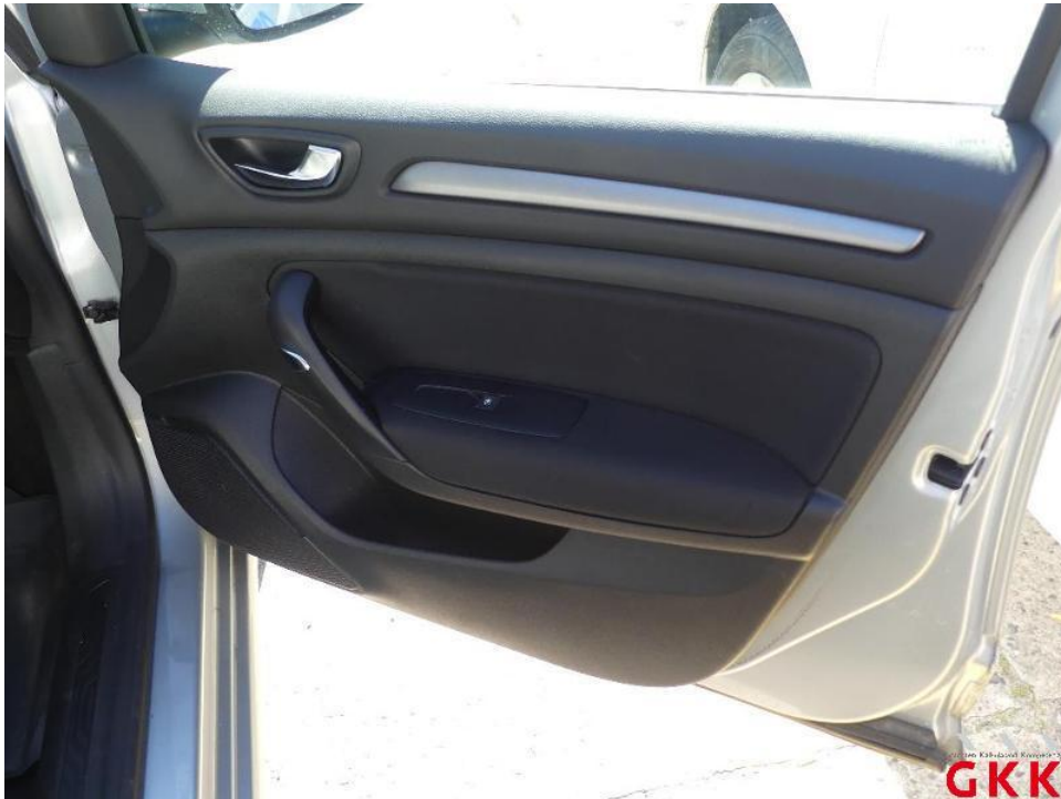
Bild 54. Tür vorne rechts, Innenverkleidung -Standard-, verkratzt, ersetzen
