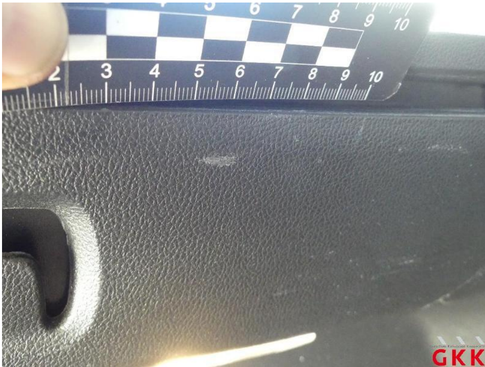
Bild 47. Seitenwand links, Innenverkleidung, verkratzt, Smartrepair
