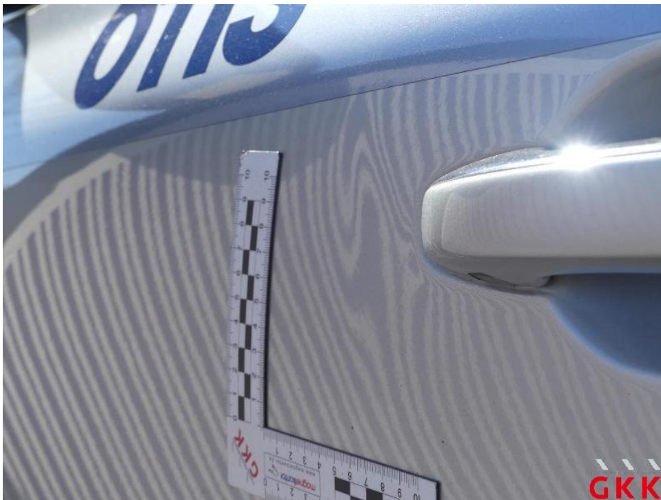
Bild 20. Tür vorne links, beschädigt, instand setzen - lackieren
