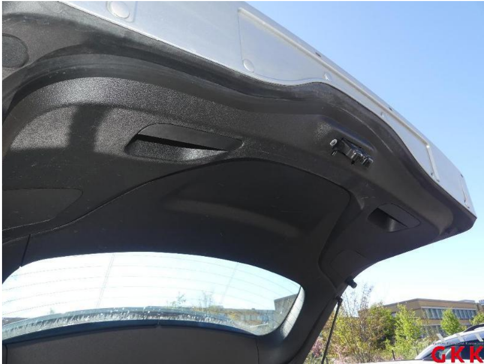
Bild 39. Heckklappe, Innenverkleidung, verkratzt, ersetzen
