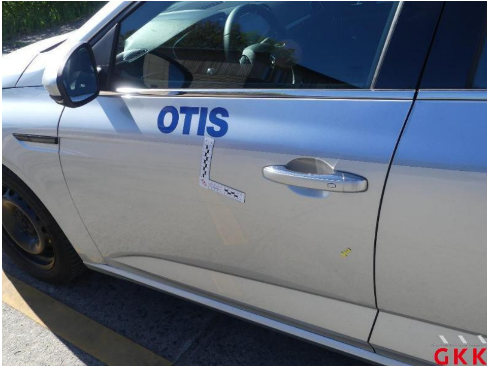
Bild 19. Tür vorne links, beschädigt, instand setzen - lackieren
