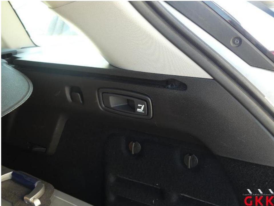
Bild 42. Seitenwand rechts, Innenverkleidung, verkratzt, Smartrepair
