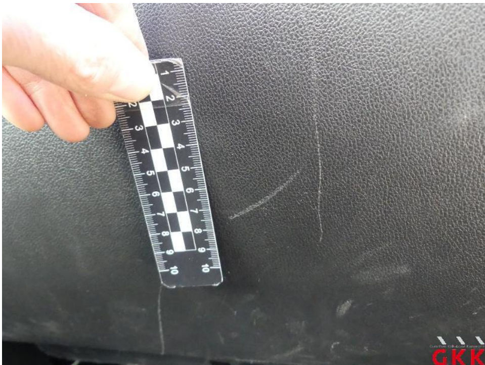
Bild 58. Handschuhfach, Deckel, verkratzt, ersetzen
