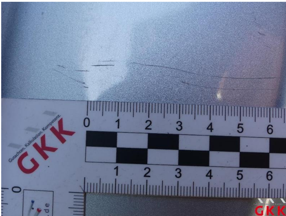
Bild 28. Tür hinten links, Einstieg, verkratzt, lackieren
