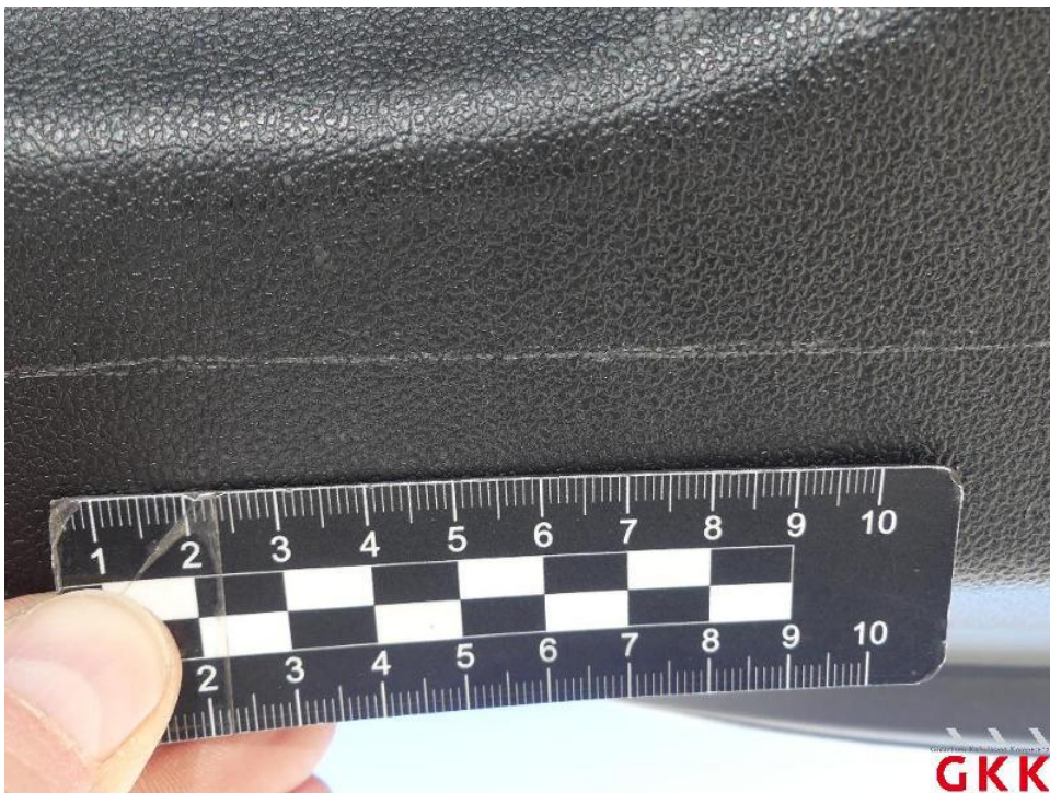
Bild 40. Heckklappe, Innenverkleidung, verkratzt, ersetzen
