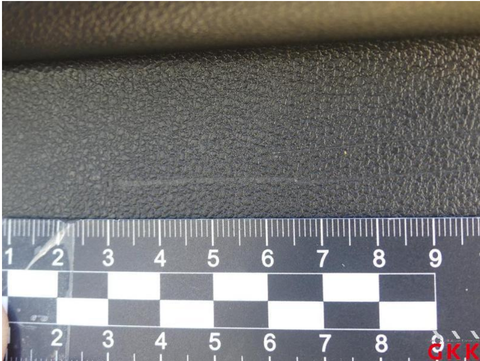
Bild 55. Tür vorne rechts, Innenverkleidung -Standard-, verkratzt, ersetzen
