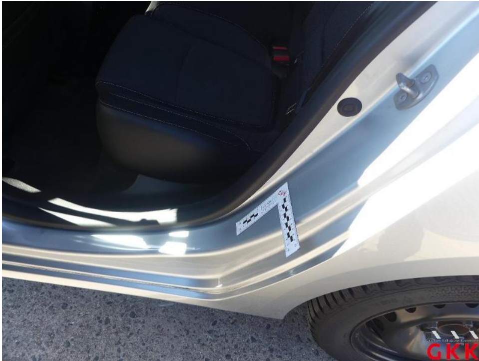
Bild 27. Tür hinten links, Einstieg, verkratzt, lackieren
