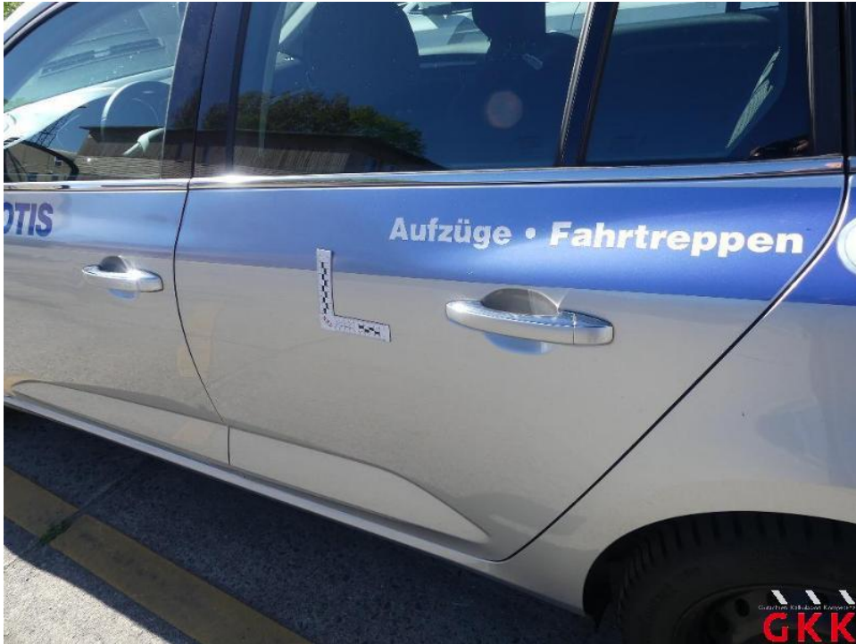
Bild 25. Tür hinten links, bis 3 Dellen / Bauteil, kalt drücken
