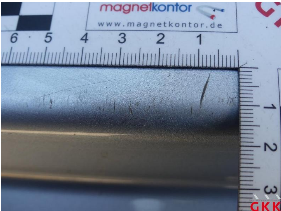
Bild 24. Tür vorne links, Einstieg, verkratzt, lackieren
