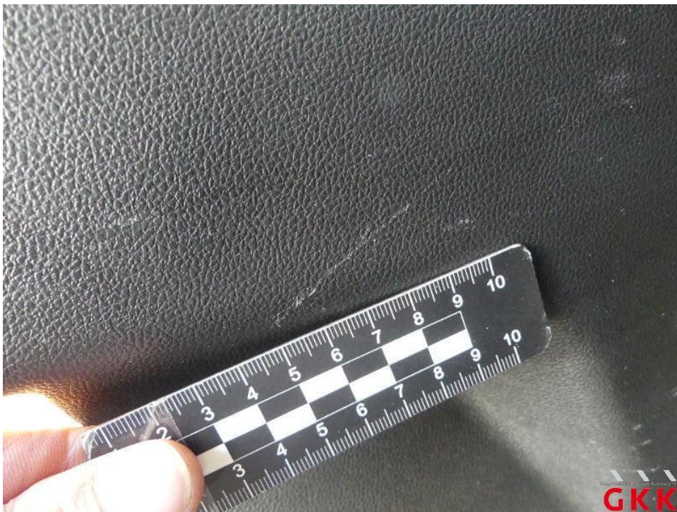
Bild 46. Seitenwand links, Innenverkleidung, verkratzt, Smartrepair
