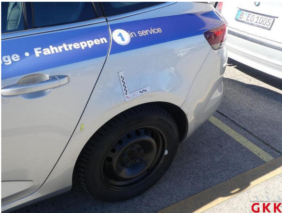
Bild 30. Seitenwand links, beschädigt, instand setzen - lackieren
