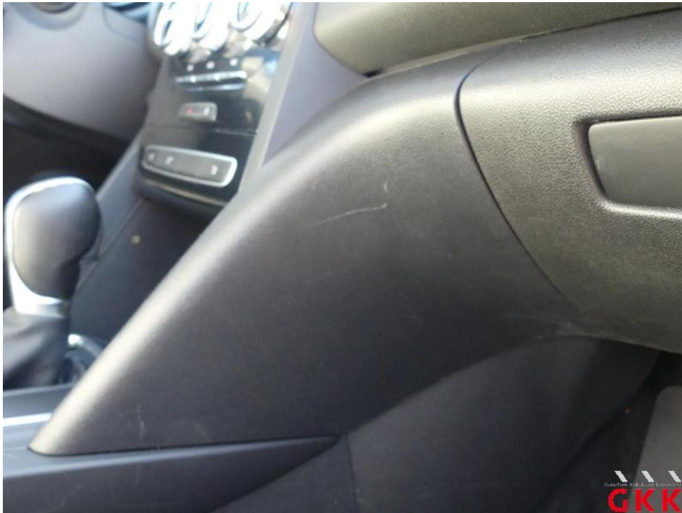
Bild 60. Mittelkonsole, Blende rechts, verkratzt, Smartrepair
