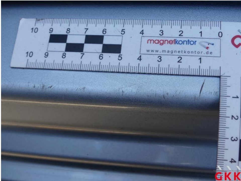
Bild 23. Tür vorne links, Einstieg, verkratzt, lackieren
