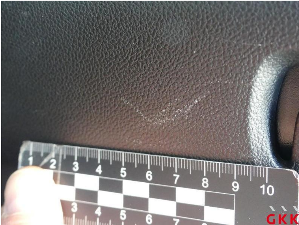
Bild 43. Seitenwand rechts, Innenverkleidung, verkratzt, Smartrepair
