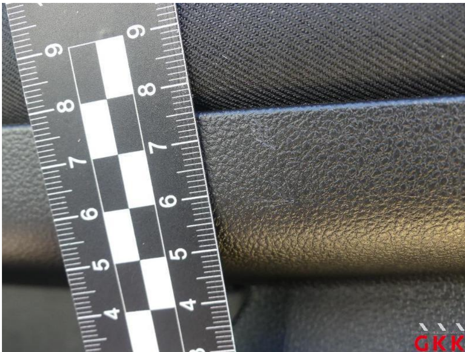
Bild 56. Tür vorne rechts, Innenverkleidung -Standard-, verkratzt, ersetzen
