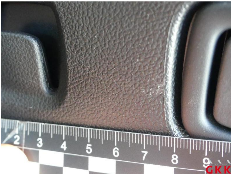
Bild 44. Seitenwand rechts, Innenverkleidung, verkratzt, Smartrepair
