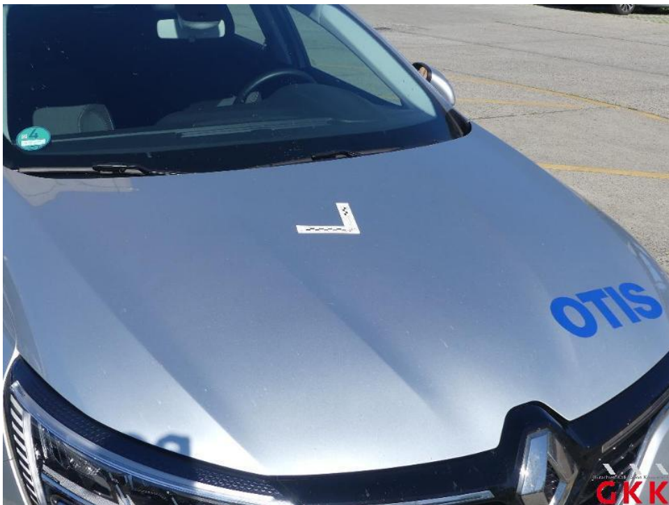
Bild 16. Motorhaube, bis 3 Dellen / Bauteil, kalt drücken
