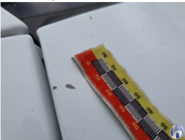
2. Motorhaube Steinschlag #0030 5 Stck./qdm - Lackieren
