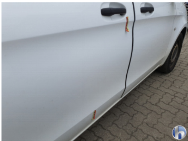
5. Schiebetür - Rechts Kratzer Tief Bis Grundierung - Smart Repair
