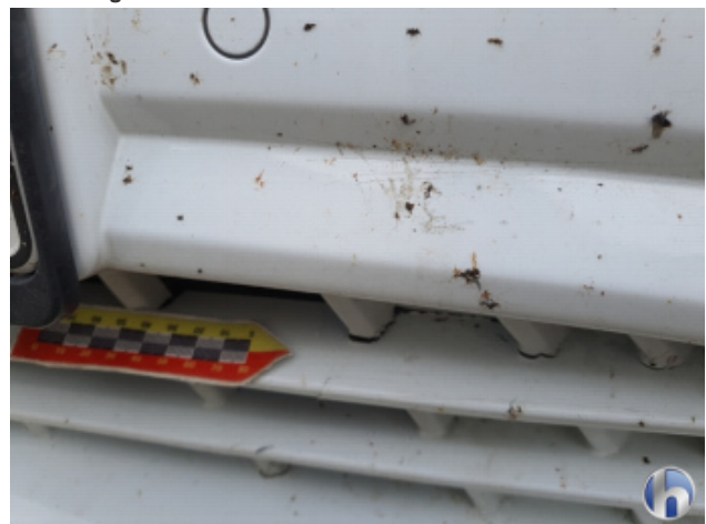
3. Stoßfänger Vorne Beschädigt - Instandsetzen und Lackieren
