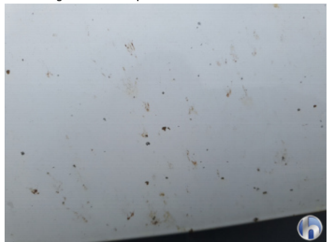
2. Motorhaube Steinschlag #0030 5 Stck./qdm - Lackieren
