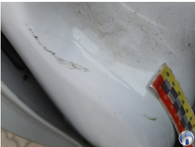
1. Türeinstieg Vorne - Rechts Kratzer - Smart Repair
