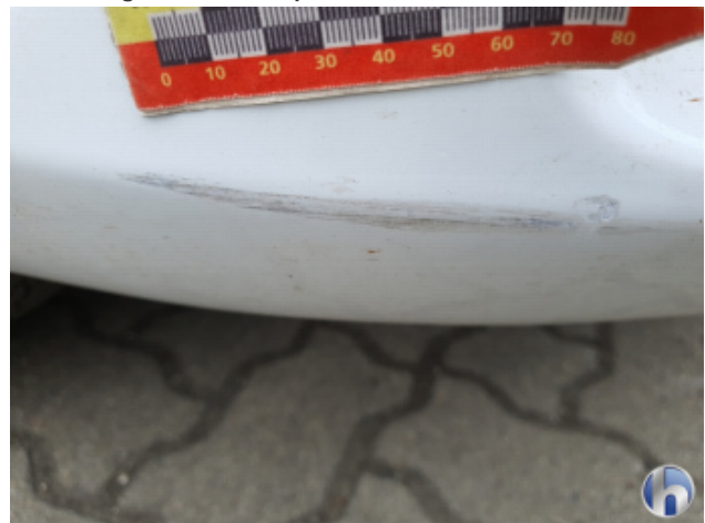
3. Stoßfänger Vorne Beschädigt - Instandsetzen und Lackieren
