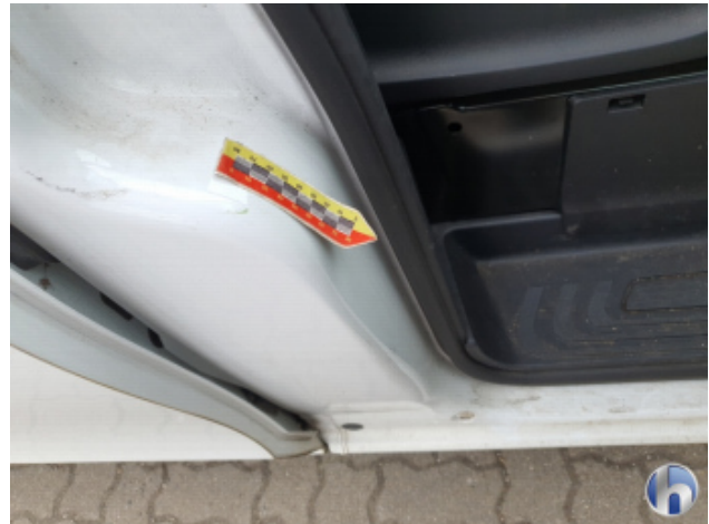
1. Türeinstieg Vorne - Rechts Kratzer - Smart Repair
