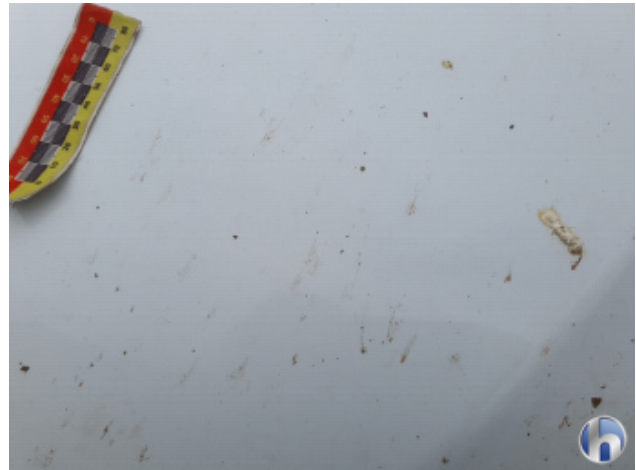
2. Motorhaube Steinschlag #0030 5 Stck./qdm - Lackieren
