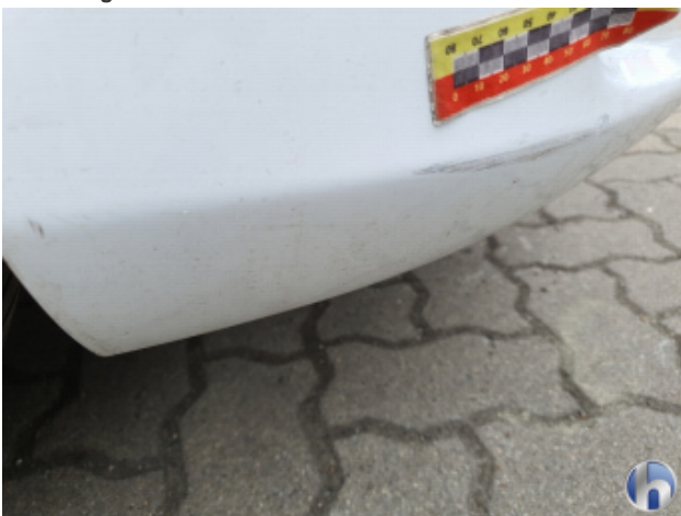
3. Stoßfänger Vorne Beschädigt - Instandsetzen und Lackieren
