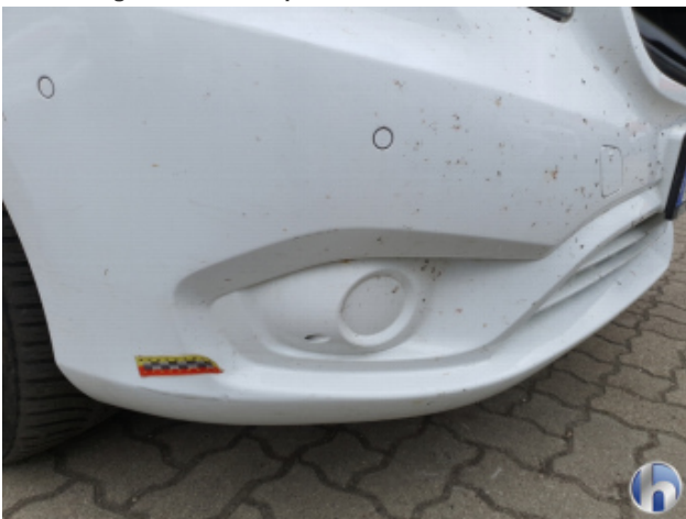
3. Stoßfänger Vorne Beschädigt - Instandsetzen und Lackieren
