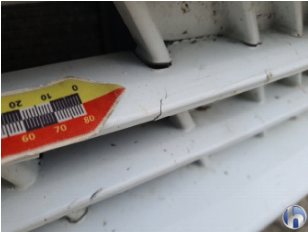
3. Stoßfänger Vorne Beschädigt - Instandsetzen und Lackieren
