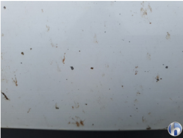
2. Motorhaube Steinschlag #0030 5 Stck./qdm - Lackieren
