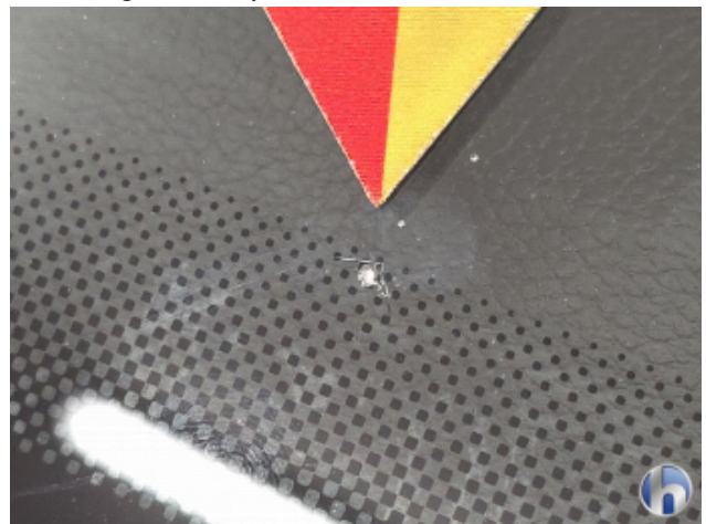
1. Windschutzscheibe Steinschlag - Smart Repair
