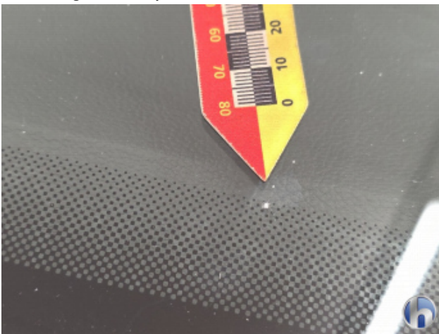
1. Windschutzscheibe Steinschlag - Smart Repair
