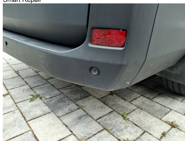
Beschädigung #2: Stossfänger hinten: Stossfänger hinten (unlackiert) - verkratzt / verschürft - Wertminderung
