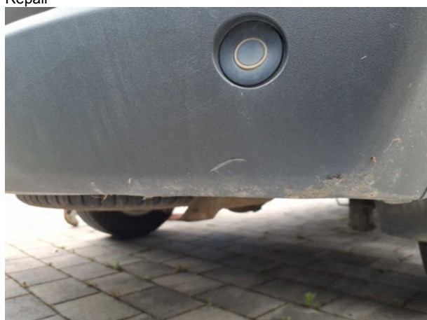
Beschädigung #2: Stossfänger hinten: Stossfänger hinten (unlackiert) - verkratzt / verschürft - Wertminderung
