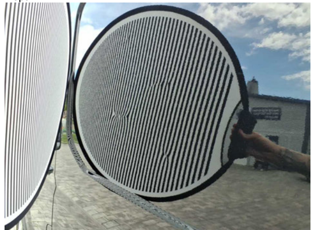
Beschädigung #5: Seitenwand links: Seitenwand - Delle(n) - Sm... Repair
