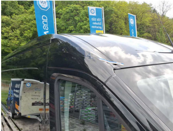
Beschädigung #8: Karosserie: A-Säule rechts - verformt - instandsetzen und lackieren
