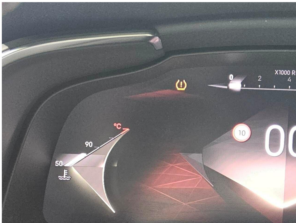
Bild 21 : Rdks meldet Fehler
