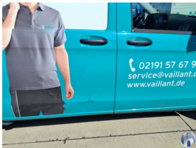
3. Tür Hinten - Rechts Beschädigt - Instandsetzen und Lackieren
