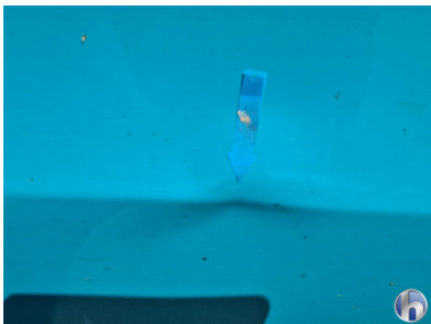
3. Tür Hinten - Rechts Beschädigt - Instandsetzen und Lackieren
