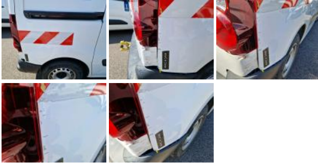
Boot door lining L, Broken, Replace
