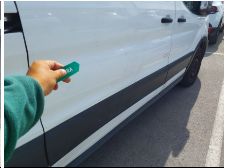
Puerta / Trasero Derecho / Abolladura
