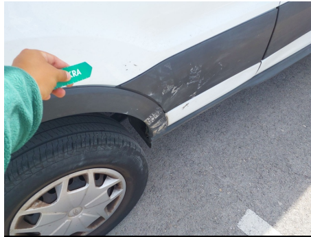
Aleta / Trasero Derecho / Abolladura
