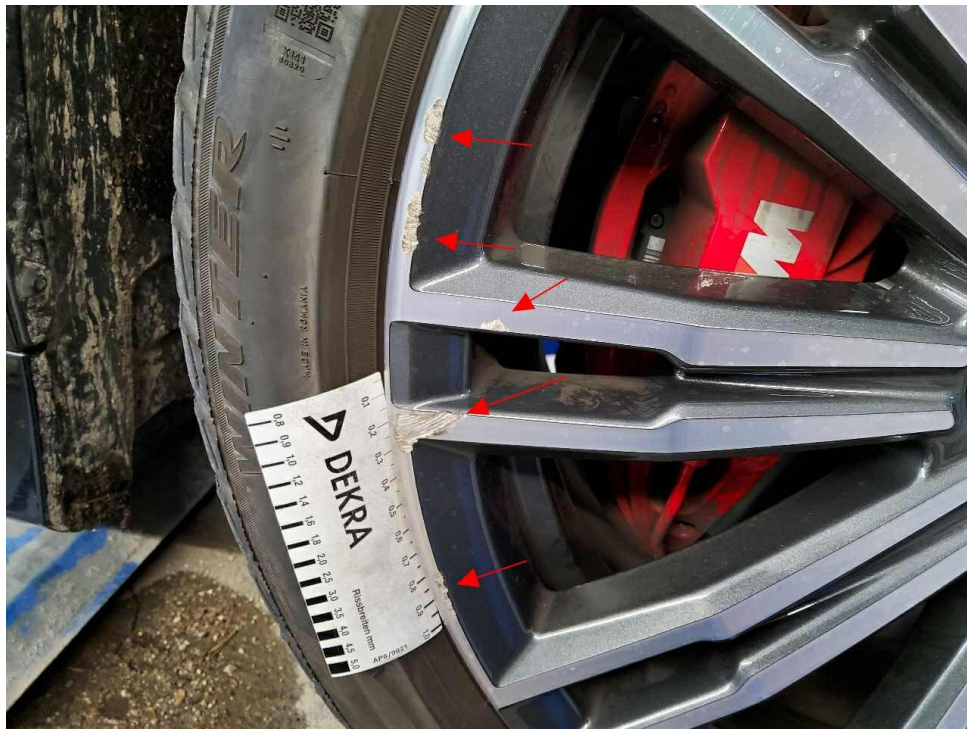
Bild 19 : LM-Felge vorne rechts (Winter), glanzgedreht, verschrammt
