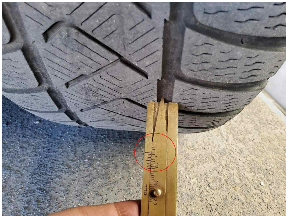
Bild 27 : Alle Winterreifen, verschlissen hinten rechts
