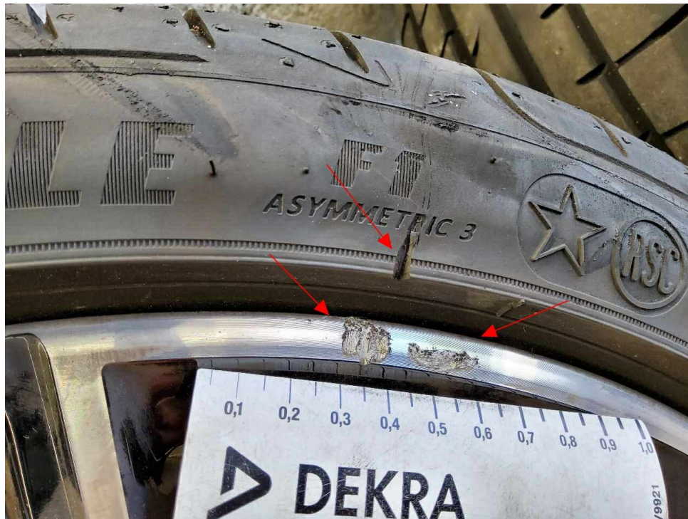
Bild 23 : LM-Felge hinten rechts (Sommer), glanzgedreht ,verschrammt Sommerreifen hinten rechts, Reifenflanke eingeschnitten
