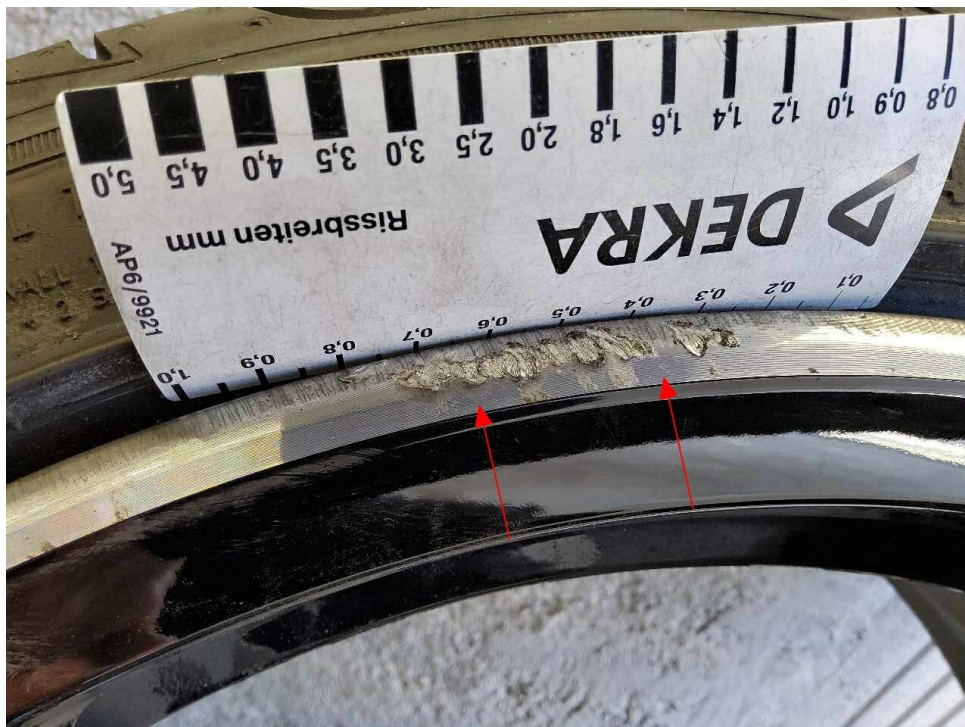
Bild 22 : LM-Felge vorne rechts (Sommer), glanzgedreht ,verschrammt
