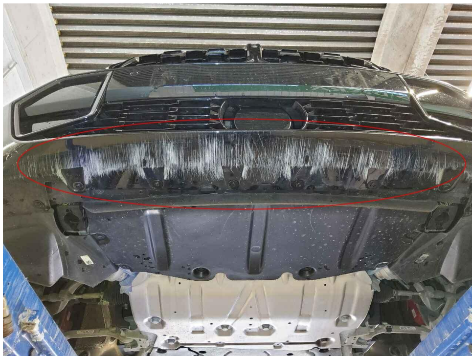
Bild 17 : Stoßfänger vorne Lackierung, verschrammt, lackieren mit Lackaufbau
