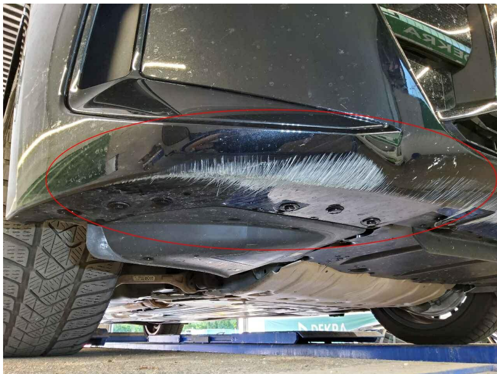
Bild 16 : Stoßfänger vorne Lackierung, verschrammt, lackieren mit Lackaufbau
