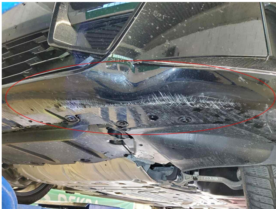
Bild 18 : Stoßfänger vorne Lackierung, verschrammt, lackieren mit Lackaufbau
