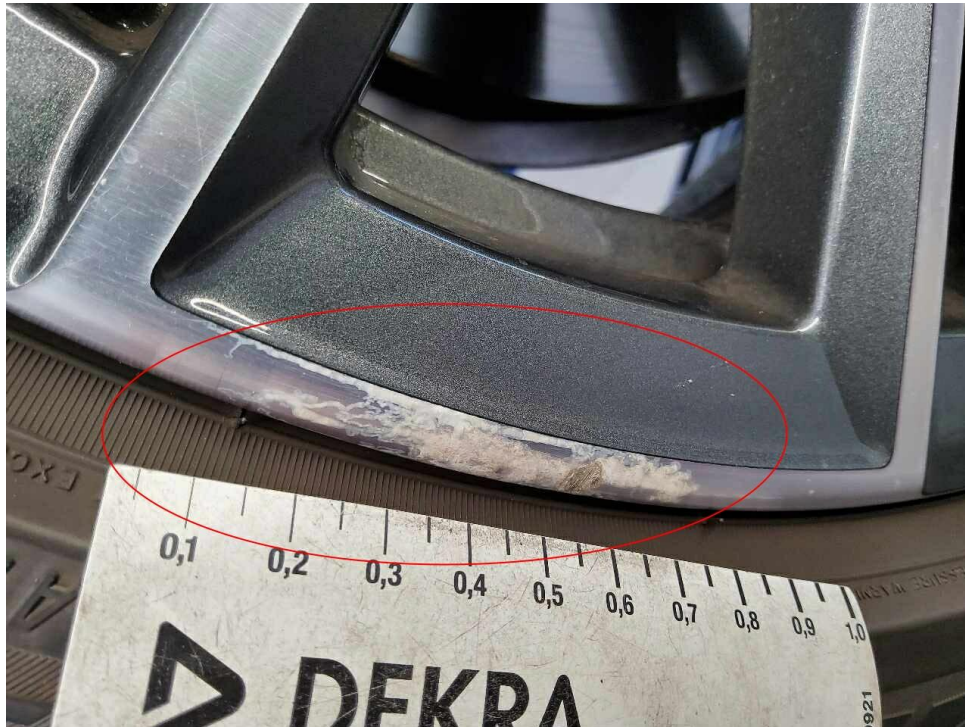
Bild 21 : LM-Felge hinten rechts (Winter), glanzgedreht, verschrammt, korrodiert
