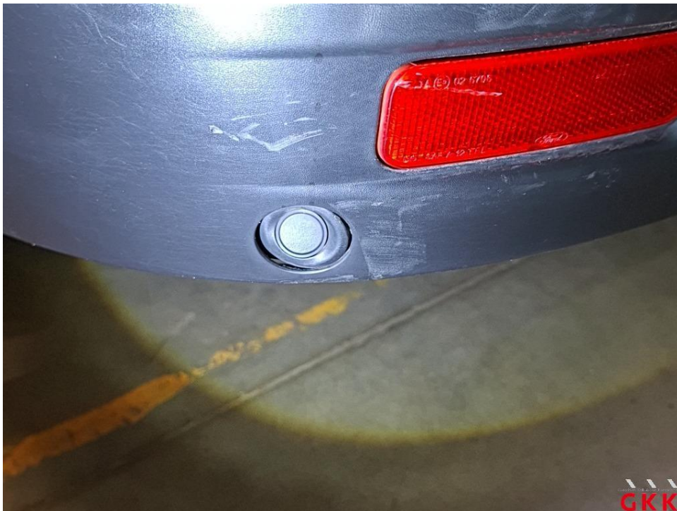
Bild 20 Stoßfänger hinten, PDC-Sensor, beschädigt, ersetzen
