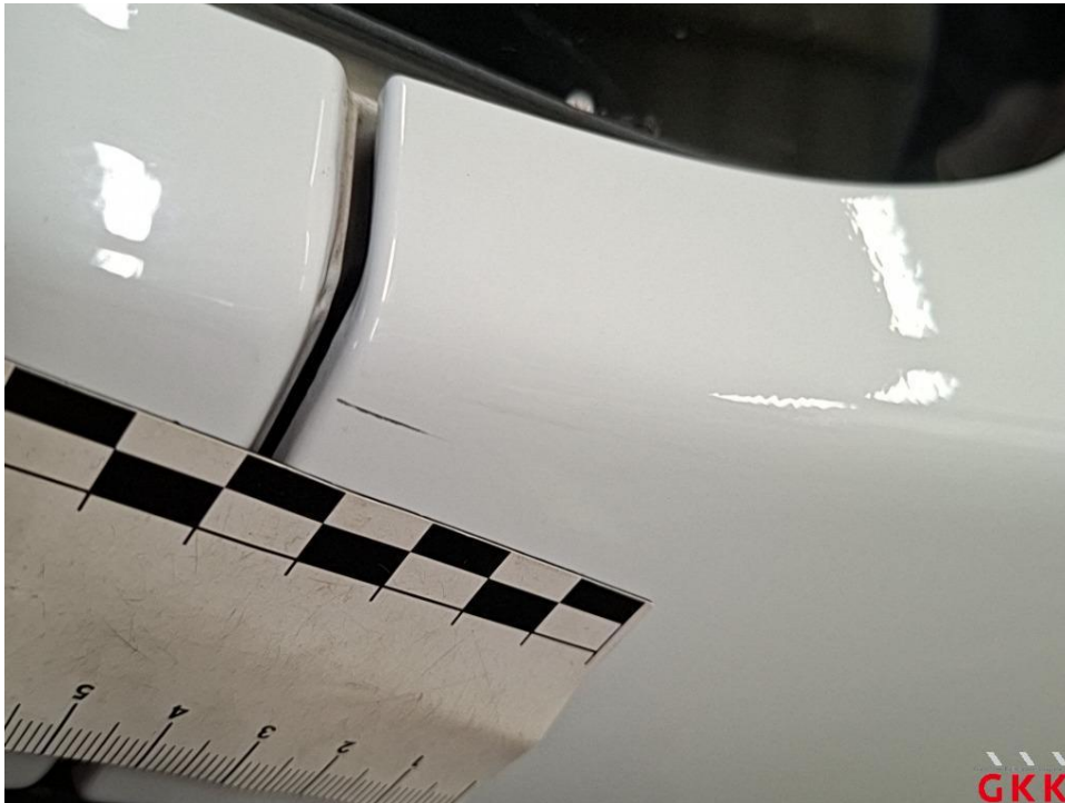
Bild 17 Kotflügel vorne rechts, verkratzt, lackieren
