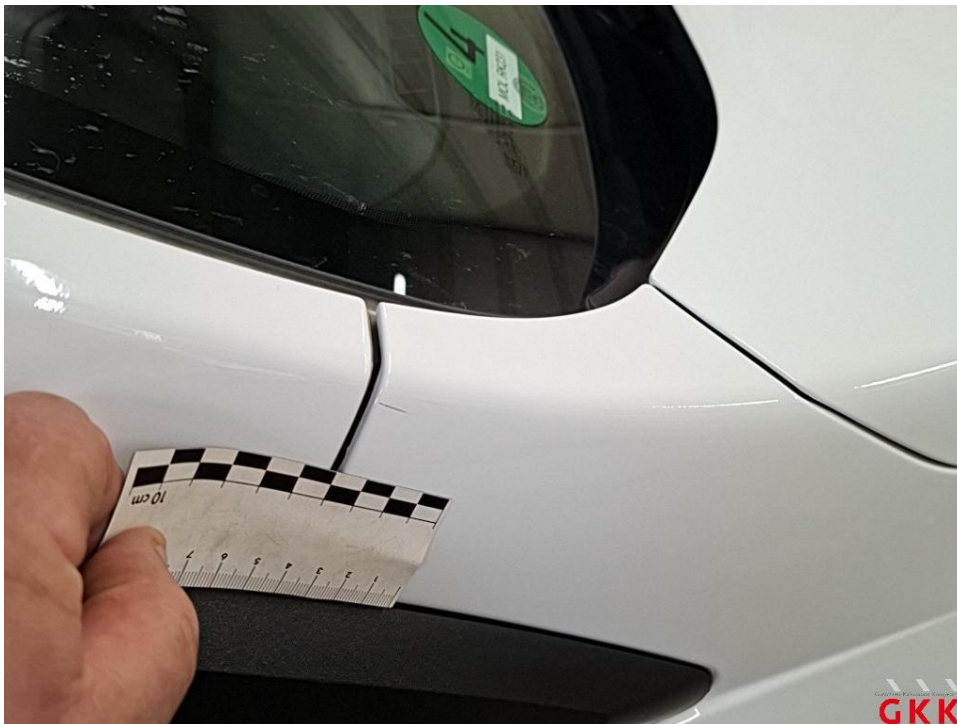
Bild 16 Kotflügel vorne rechts, verkratzt, lackieren
