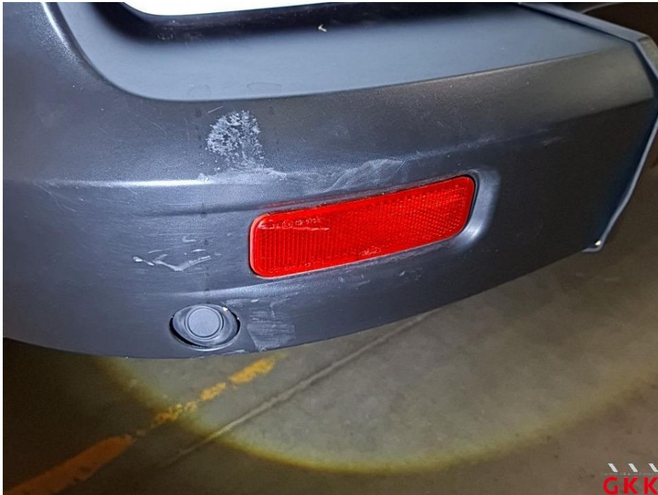
Bild 19 Stoßfänger hinten, Ecke links -unlackiert-, beschädigt, ersetzen
