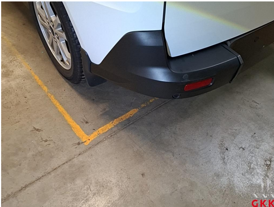
Bild 18 Stoßfänger hinten, Ecke links -unlackiert-, beschädigt, ersetzen
