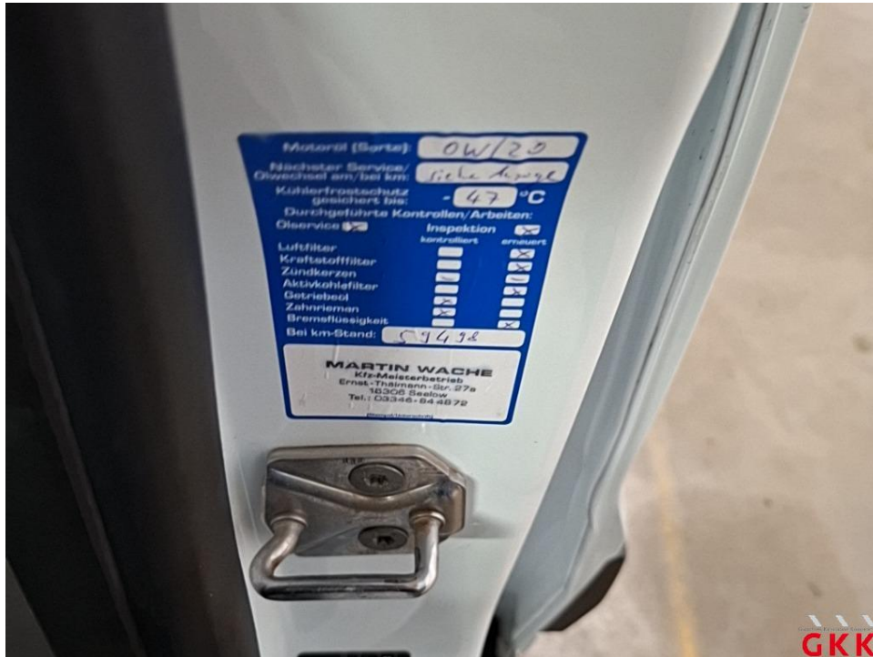
Bild 13 Inspektion groß, Kleintransporter, kein gültiger Nachweis vorhanden, durchführen
