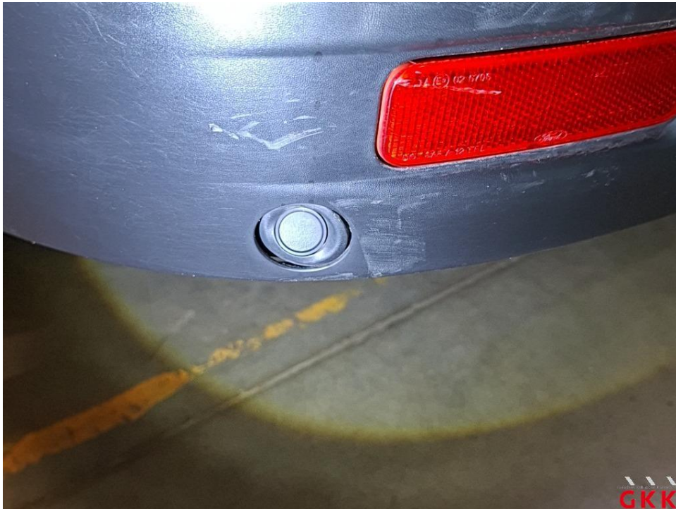
Bild 21 Stoßfänger hinten, Reflektor, beschädigt, ersetzen
