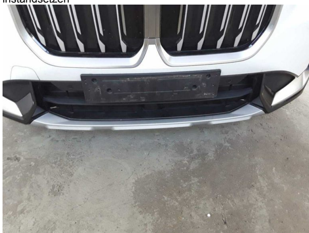
Beschädigung #2: Stossfänger vorn: Spoiler - verkratzt / versch... - Wertminderung
