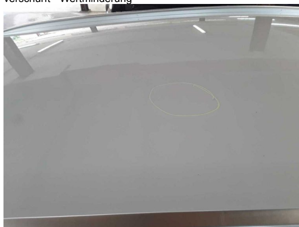
Beschädigung #3: Fahrzeugdach: Dach - Delle(n) - sanft instandsetzen
