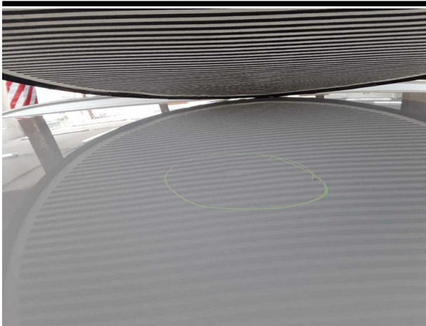
Beschädigung #3: Fahrzeugdach: Dach - Delle(n) - sanft instandsetzen
