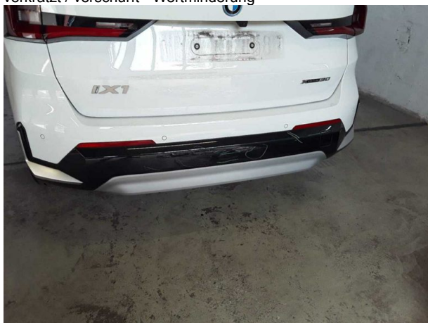
Beschädigung #7: Stossfänger hinten: Spoiler - verkratzt / verschürft - erneuern
