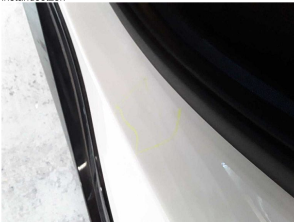
Beschädigung #4: Seitenwand links: Einstieg - Delle(n) - Smart Repair
