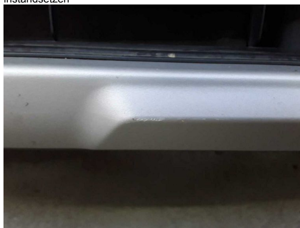
Beschädigung #2: Stossfänger vorn: Spoiler - verkratzt / verschürft - Wertminderung
