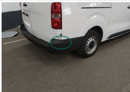
Stoßfänger / Hinten Rechts / Nicht konform
