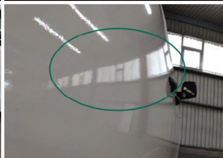
Tür / Rechts / Schlecht Repariert
