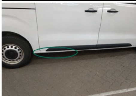
Schweller / Hinten Rechts / Schlecht Repariert
