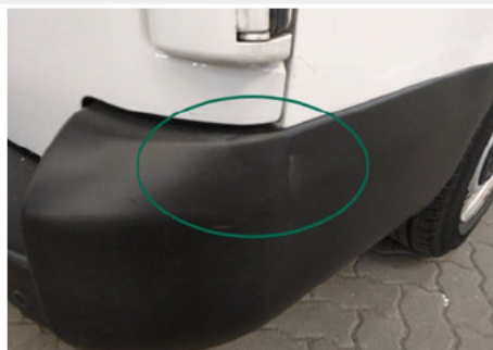
Stoßfänger / Hinten Rechts / Nicht konform
