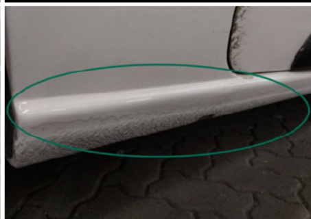
Schweller / Hinten Rechts / Schlecht Repariert
