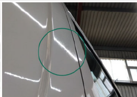
Tür / Rechts / Schlecht Repariert
