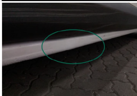
Schweller / Hinten Rechts / Schlecht Repariert
