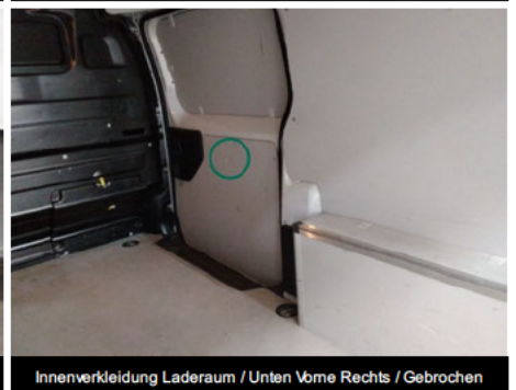
Innenverkleidung Laderaum / Unten Vorne Rechts / Gebrochen
