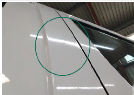
Tür / Rechts / Schlecht Repariert
