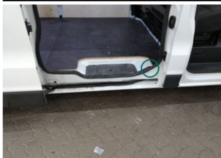
Dichtung Türeinstieg / Rechts / Gebrochen
