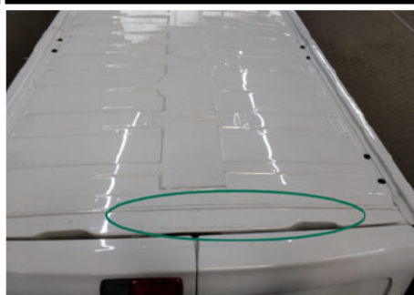
Dachholm / Hinten / Delle
