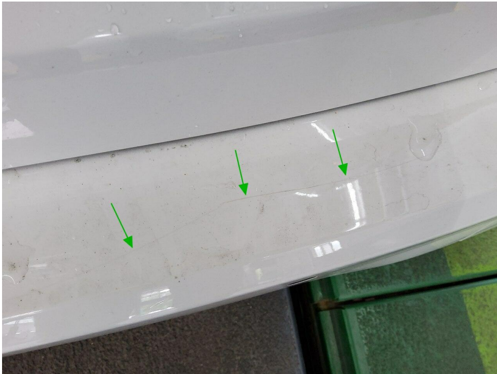
Bild 23 : Stoßfänger hinten (Ladekante), zerkratzt
