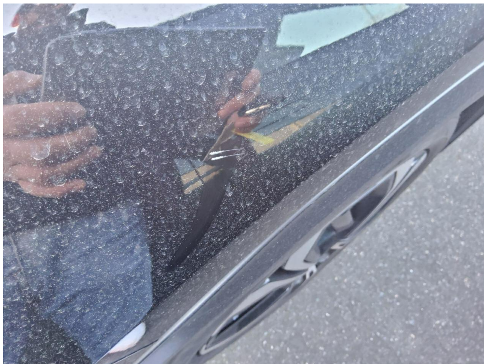
Bild 14 : Kotflügel vorne links Lackierung, verschrammt, lackieren mit Lackaufbau
