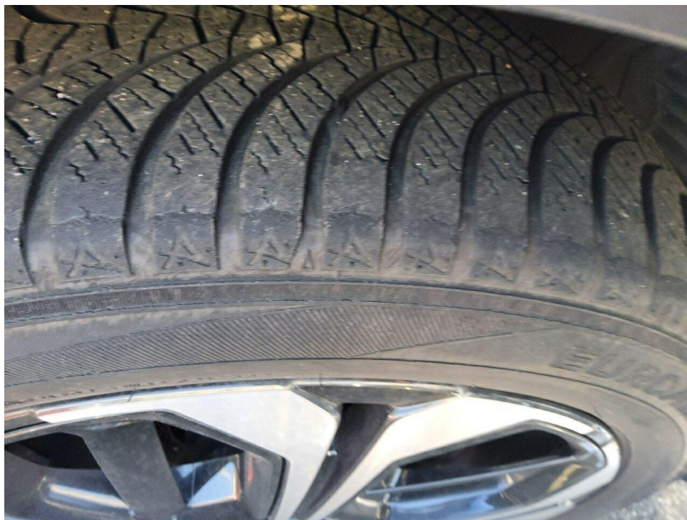
Bild 8 : Reifen vorne außen abgefahren
