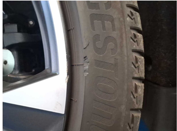
Beschädigung #1: Rad/Reifen: Rad/Reifen (Hinten Rechts) - beschädigt - erneuern
