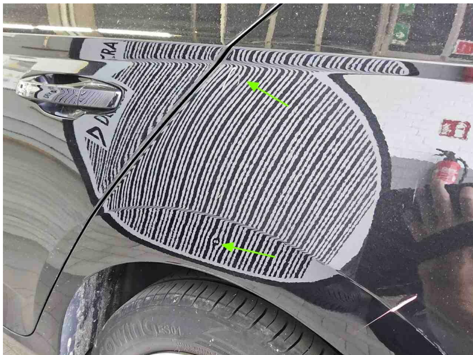
Bild 24 : Seitenteil hinten links, verformt, instandsetzen und lackieren mit Lackaufbau
