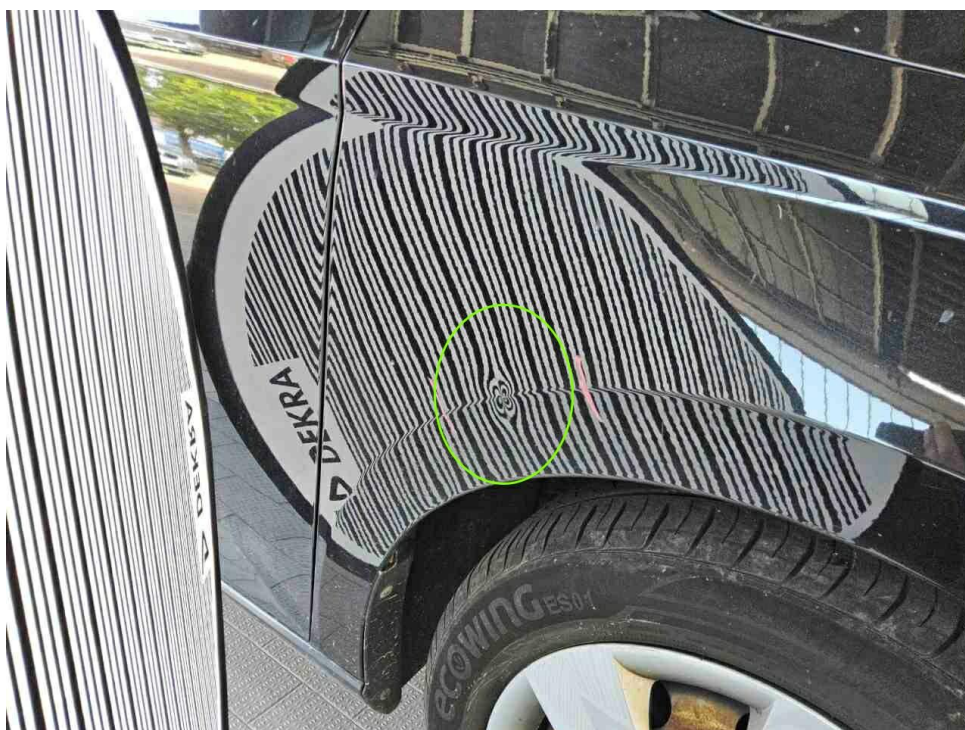
Bild 16 : Kotflügel vorne rechts, verformt, instandsetzen und lackieren mit Lackaufbau
