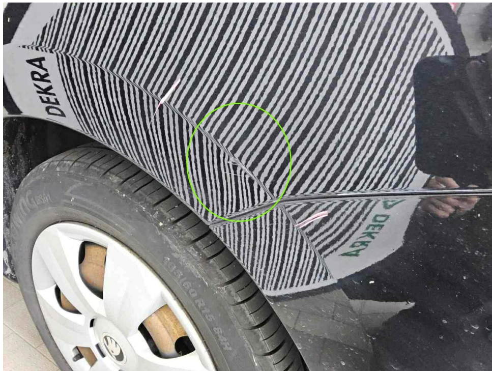
Bild 23 : Seitenteil hinten links, verformt, instandsetzen und lackieren mit Lackaufbau
