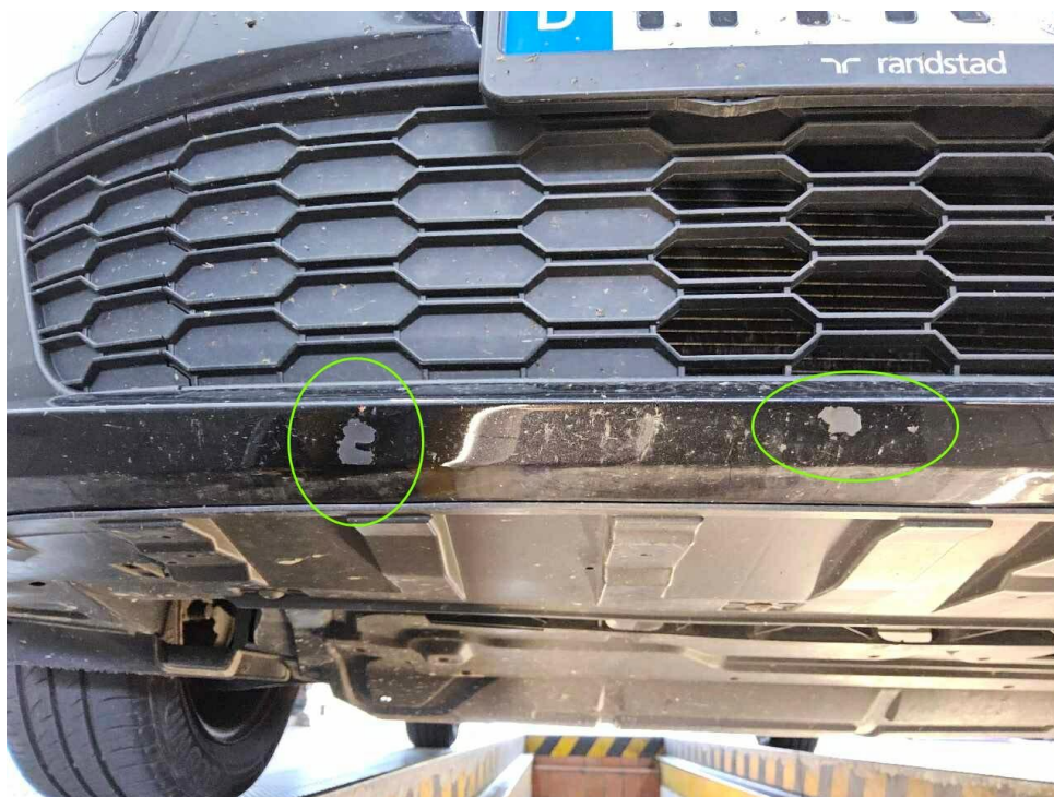
Bild 28 : Frontspoiler Lackierung, gerissen, lackieren mit Lackaufbau
