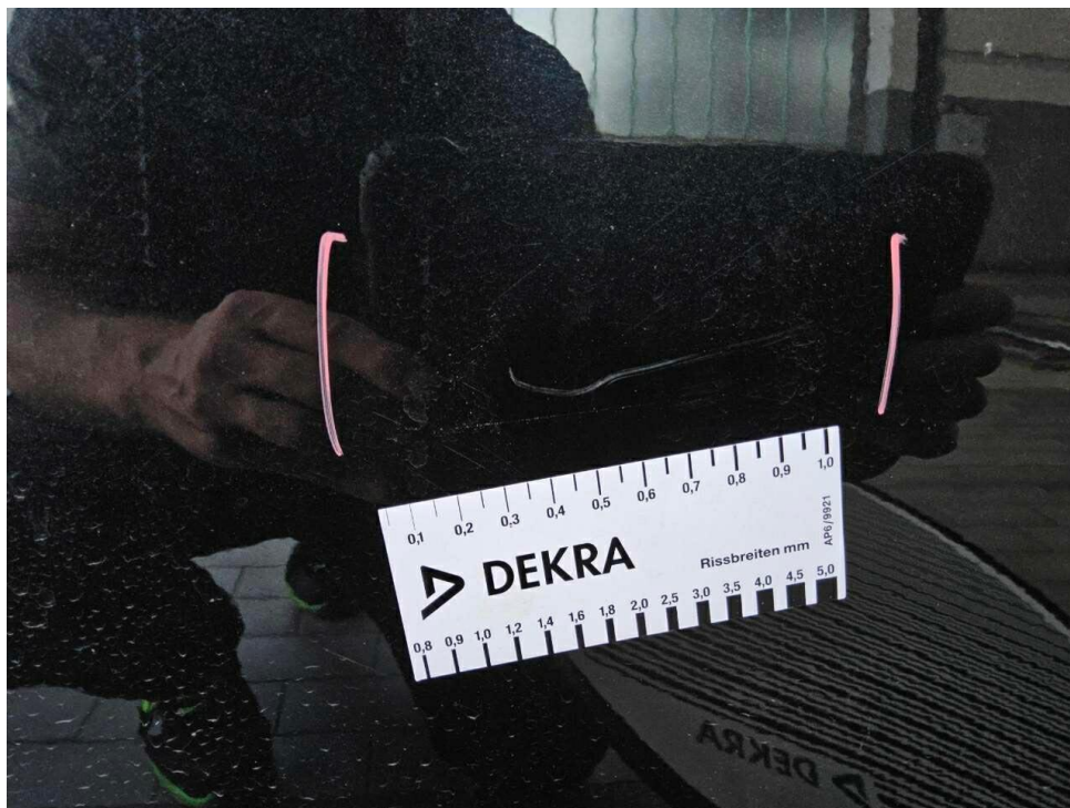
Bild 31 : Tür vorne rechts Lackierung, zerkratzt, polieren
