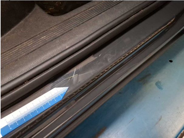
Beschädigung #3: Seitenwand rechts: Einstieg - Kratzer - Smart Repair
