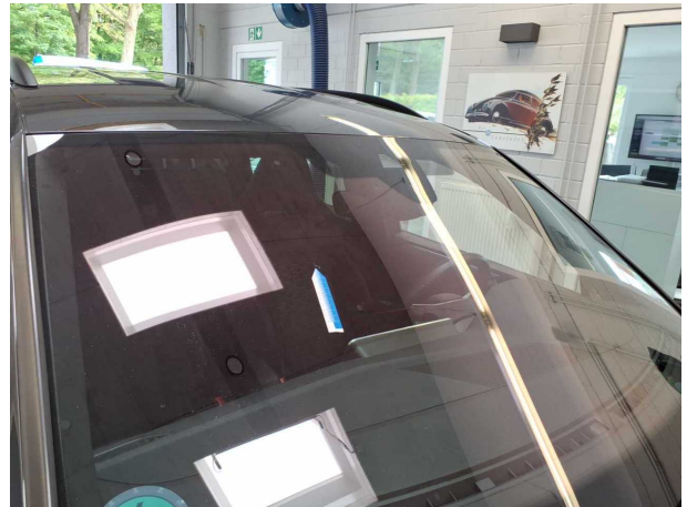
Beschädigung #10: Verglasung: Frontscheibe - Steinschlag - erneuern
