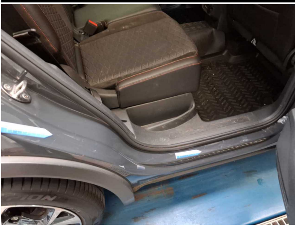
Beschädigung #3: Seitenwand rechts: Einstieg - Kratzer - Smart Repair
