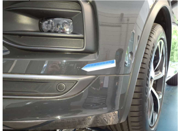
Beschädigung #4: Stossfänger vorn: Stossfänger vorn - Kratzer - Smart Repair
