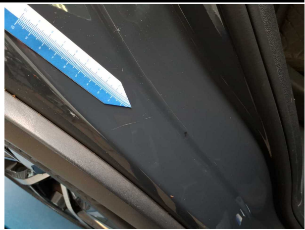
Beschädigung #3: Seitenwand rechts: Einstieg - Kratzer - Smart Repair
