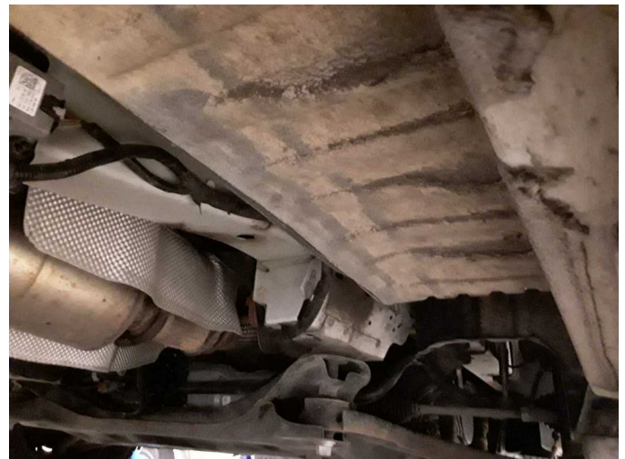
Damage 12: Body: Underbody (Einstieg rechts) - Deformed - Replace
