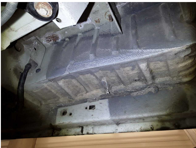
Damage 12: Body: Underbody (Einstieg rechts) - Deformed - Replace
