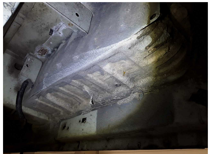
Damage 12: Body: Underbody (Einstieg rechts) - Deformed - Replace
