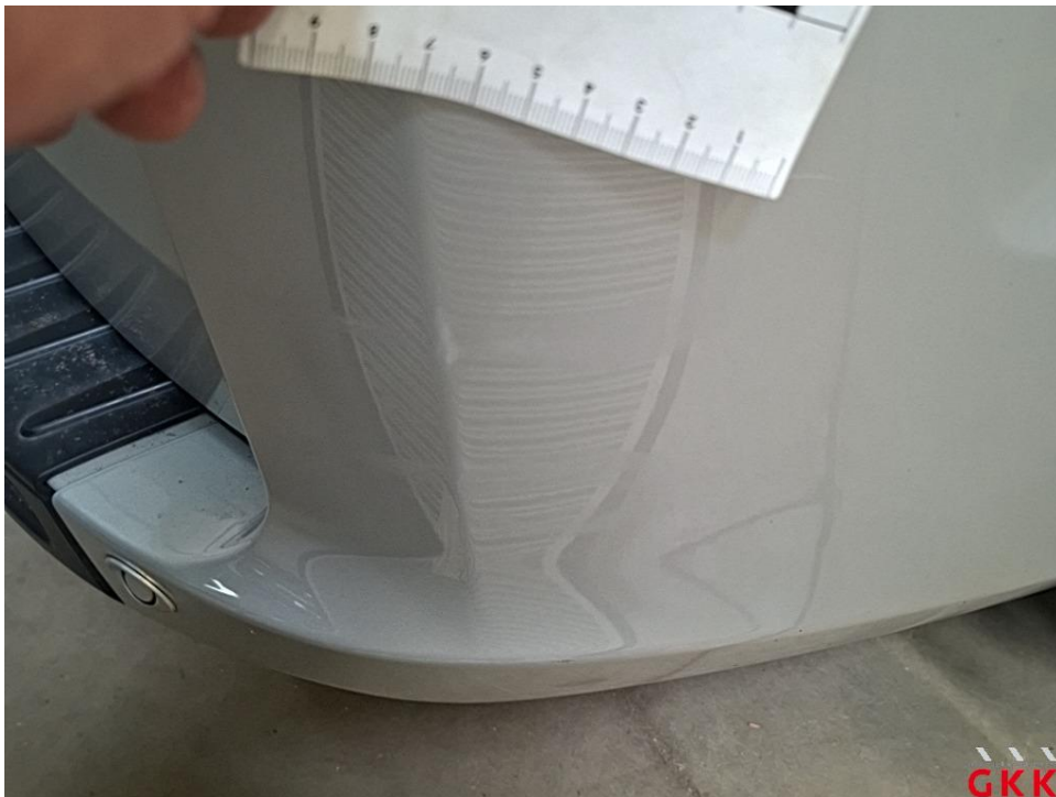
Bild 26 Stoßfänger hinten, Ecke rechts -lackiert-, verkratzt, lackieren
