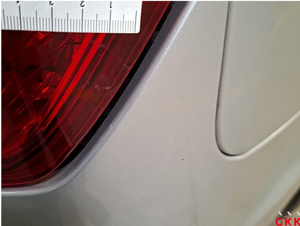
Bild 29 Rückleuchte rechts, außen, verkratzt, ersetzen
