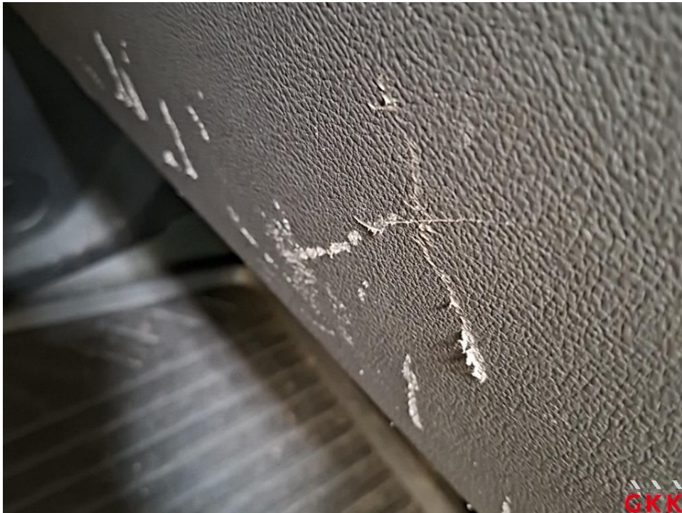
Bild 15 Handschuhfach, Deckel, beschädigt, ersetzen
