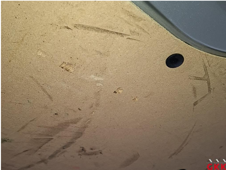
Bild 37 Heckklappe, Innenverkleidung, beschädigt, ersetzen
