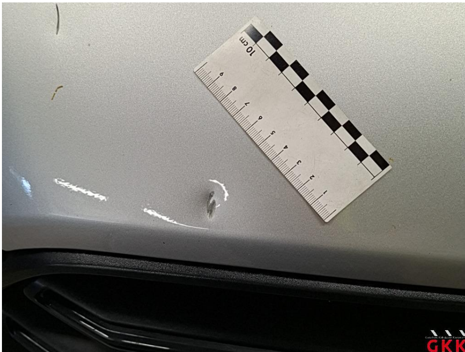
Bild 22 Motorhaube, beschädigt, instand setzen - lackieren
