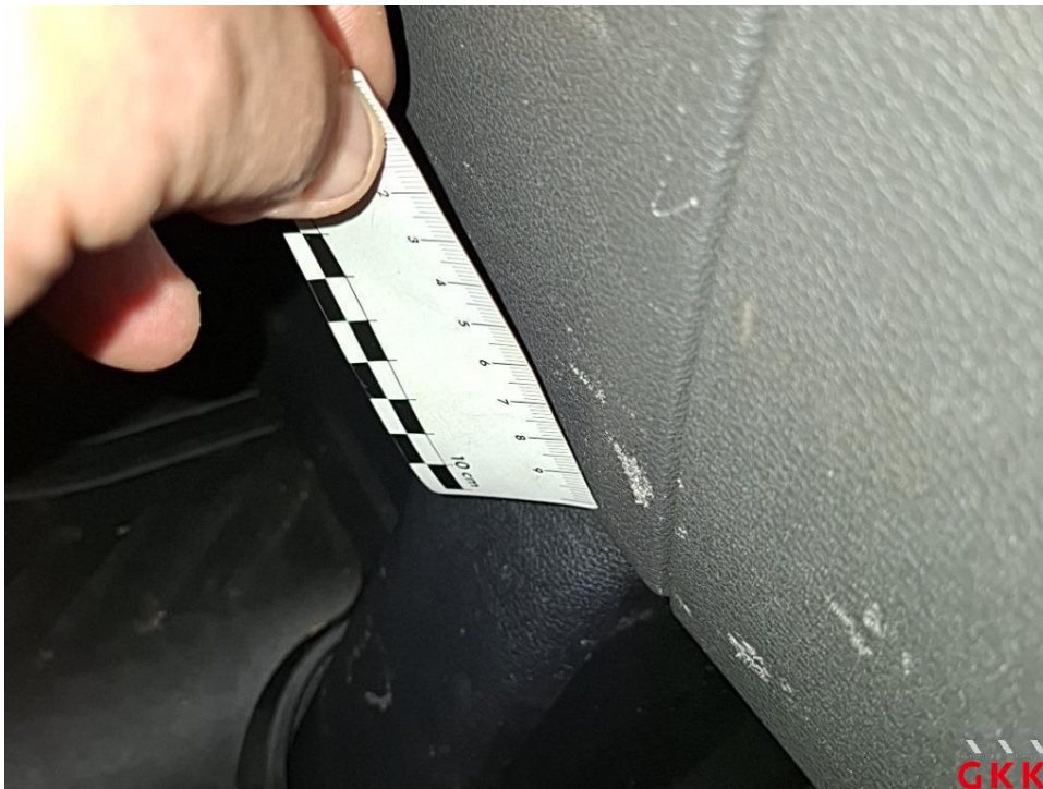
Bild 34 Fahrzeug, innen, verkratzt und verschmutzt, aufbereiten
