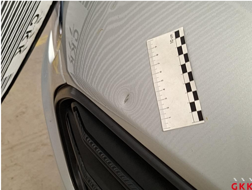
Bild 21 Motorhaube, beschädigt, instand setzen - lackieren
