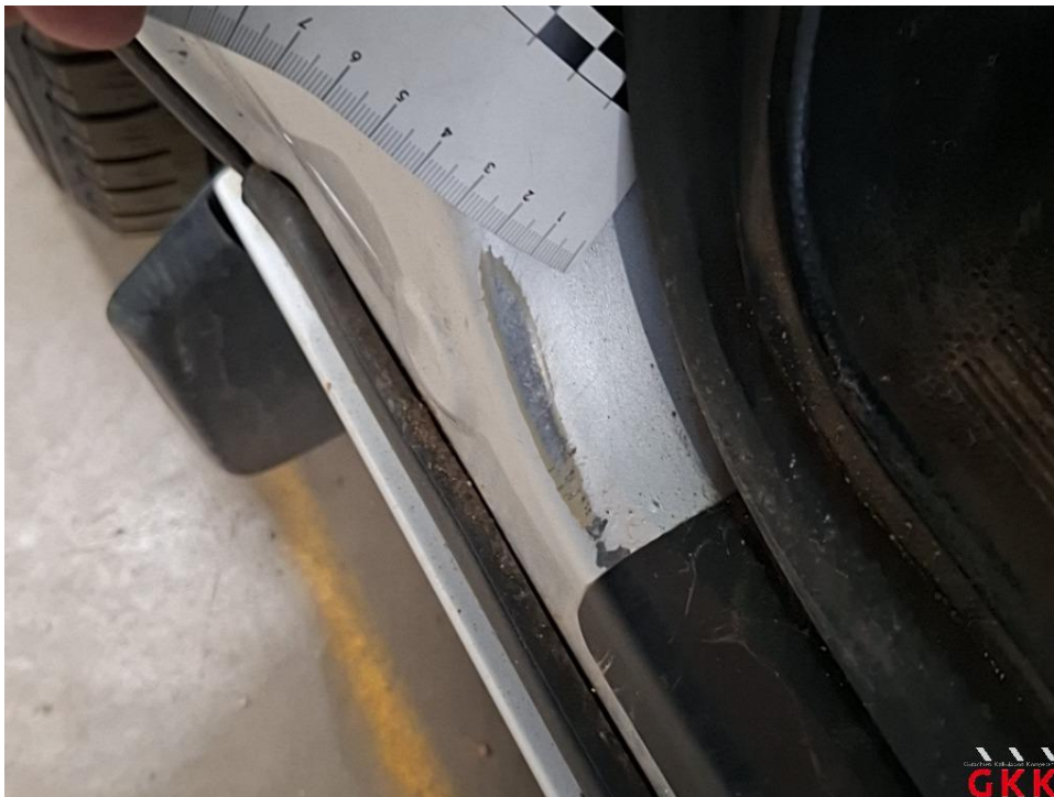
Bild 24 Tür vorne links, Einstieg, verkratzt, Smartrepair
