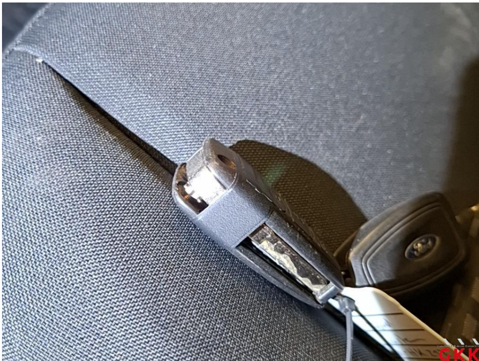
Bild 16 Hauptschlüssel, mit Fernbedienung, beschädigt, ersetzen
