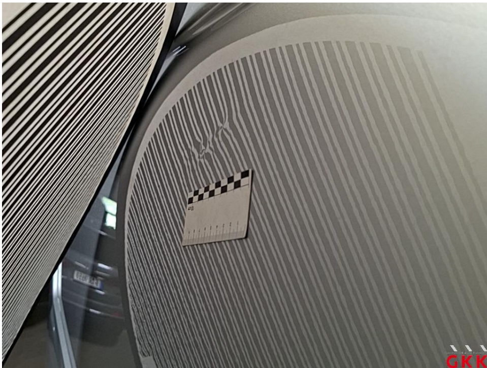
Bild 32 Seitenwand rechts, oberhalb, beschädigt, instand setzen - lackieren
