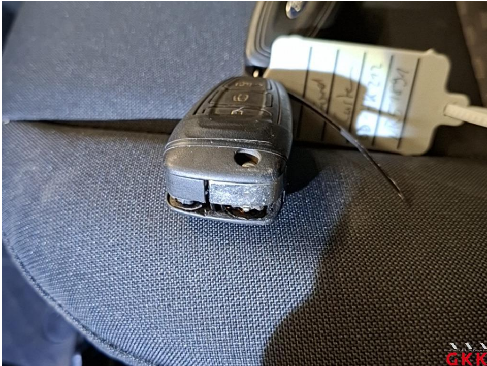
Bild 17 Hauptschlüssel, mit Fernbedienung, beschädigt, ersetzen
