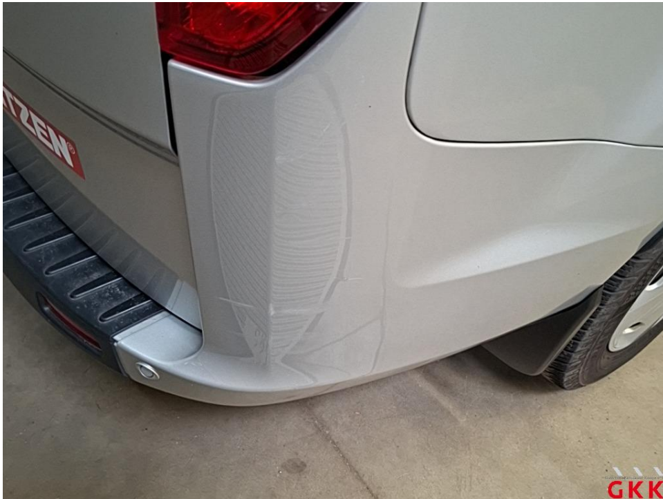
Bild 25 Stoßfänger hinten, Ecke rechts -lackiert-, verkratzt, lackieren
