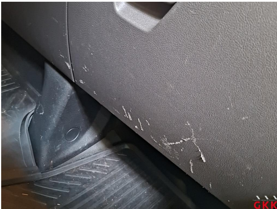
Bild 14 Handschuhfach, Deckel, beschädigt, ersetzen
