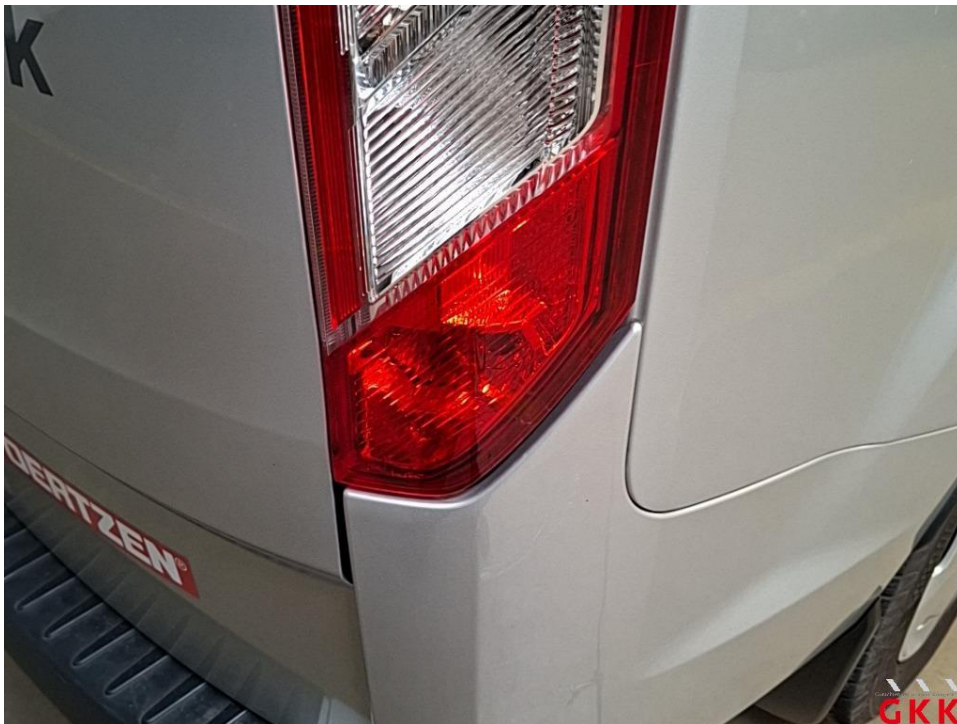
Bild 28 Rückleuchte rechts, außen, verkratzt, ersetzen
