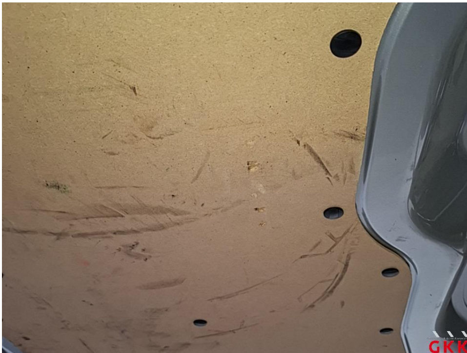
Bild 36 Heckklappe, Innenverkleidung, beschädigt, ersetzen
