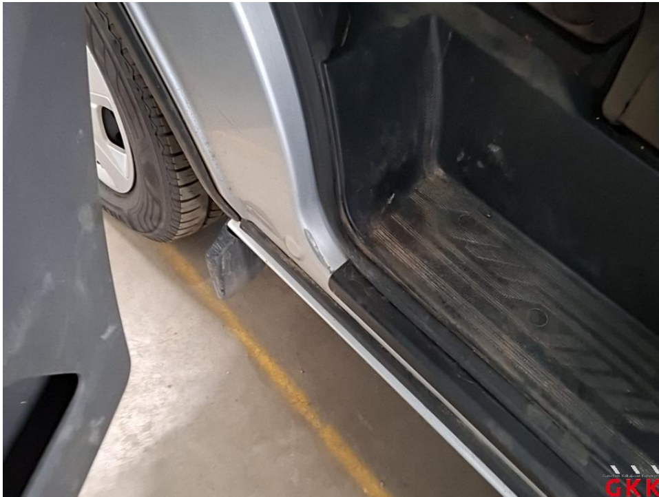
Bild 23 Tür vorne links, Einstieg, verkratzt, Smartrepair
