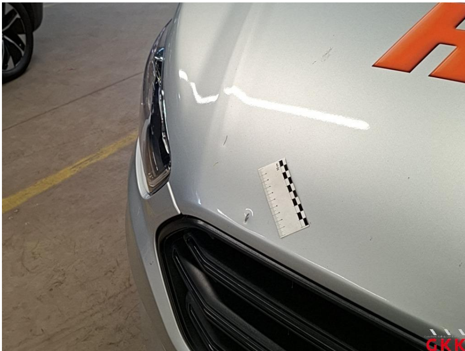
Bild 20 Motorhaube, beschädigt, instand setzen - lackieren
