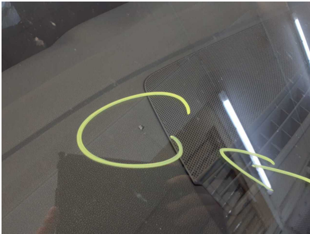
Beschädigung #8: Verglasung: Frontscheibe mit Spurhalteassistent - Steinschlag - erneuern
