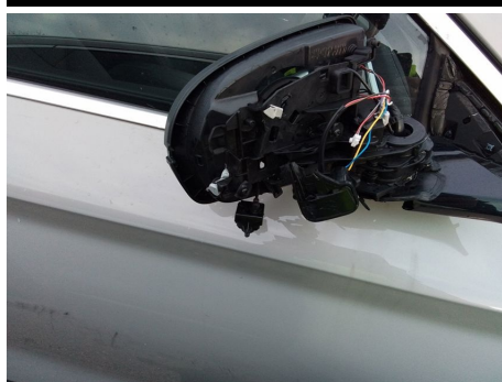
Indicatore di direzione / Destro / Rotto
