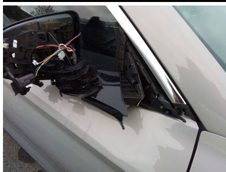
Retrovisore elettrico / Destro / Rotto
