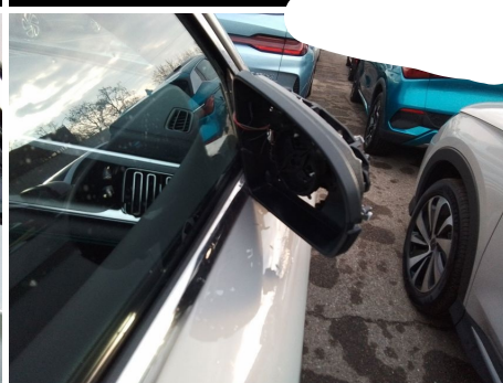
Vetro retrovisore / Destro / Rotto
