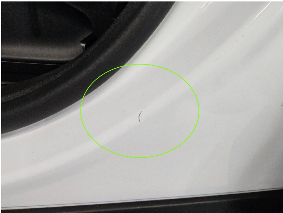
Bild 14 : Einstieg vorne links, verschrammt
