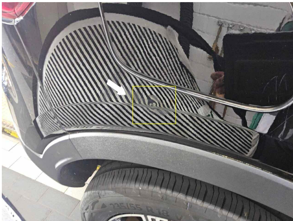
Bild 28 : Seitenteil hinten rechts, eingedellt / zerkratzt
