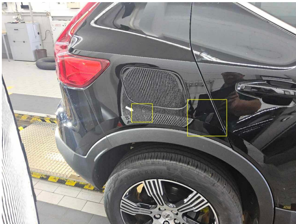
Bild 27 : Seitenteil hinten rechts, eingedellt / zerkratzt
