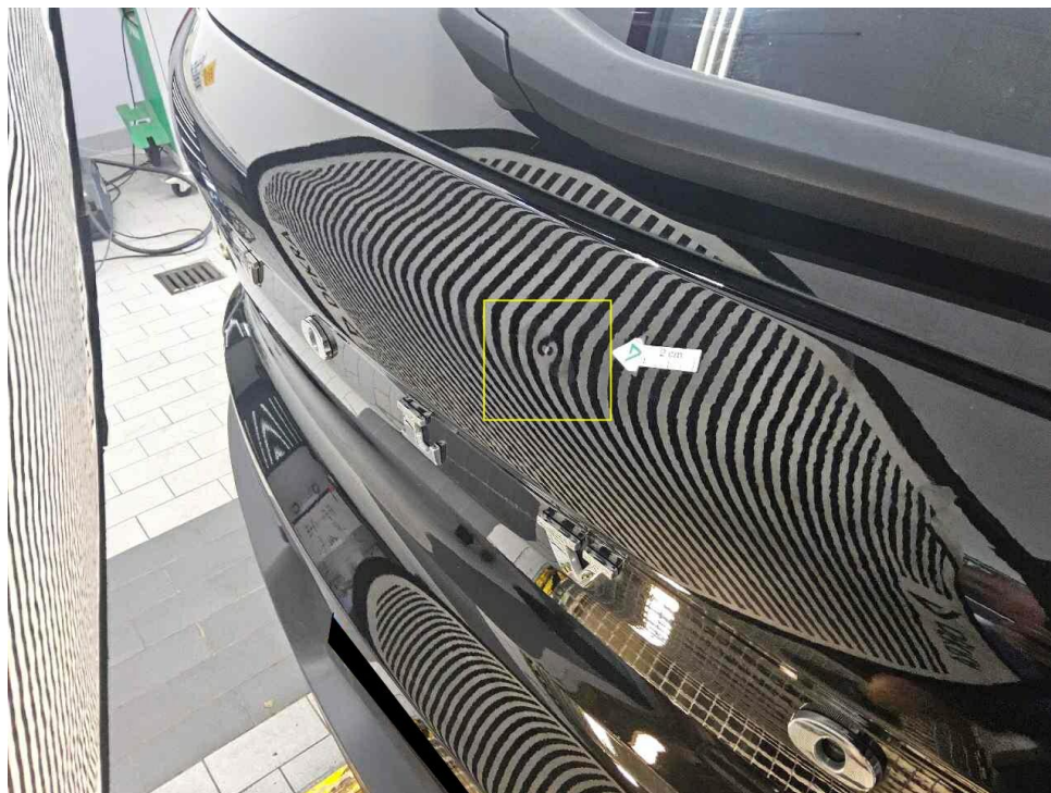
Bild 31 : Heckklappe, eingedellt / zerkratzt
