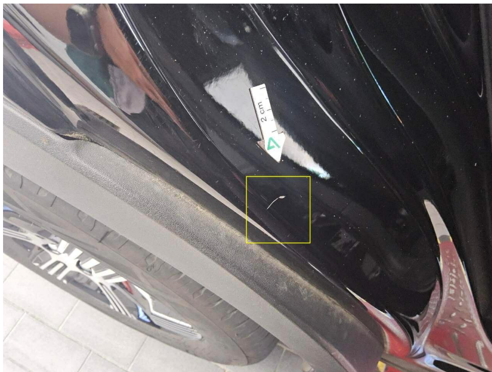
Bild 37 : Tür hinten rechts Einstieg, zerkratzt
