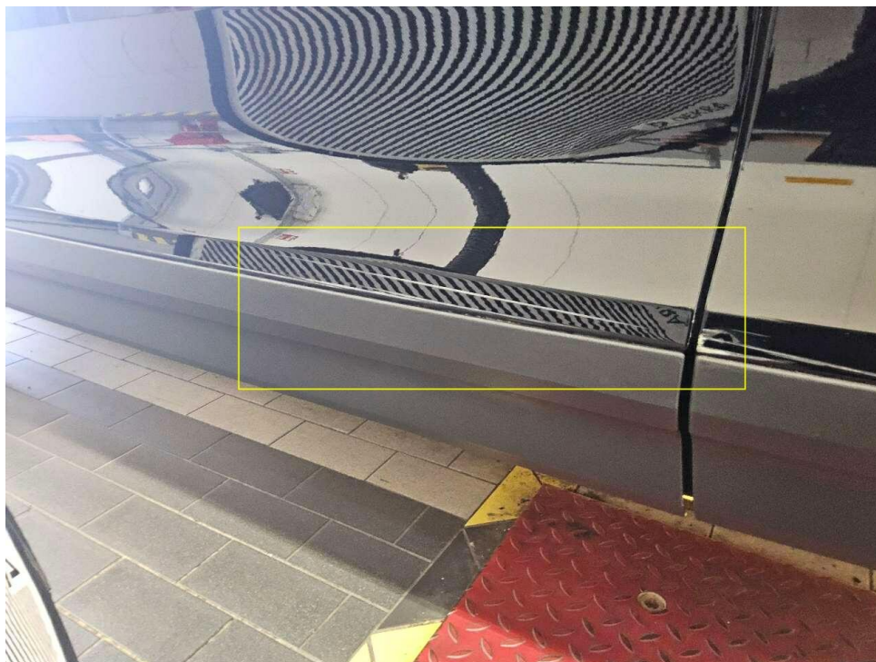
Bild 19 : Tür vorne links / Tür hinten links, eingedrückt
