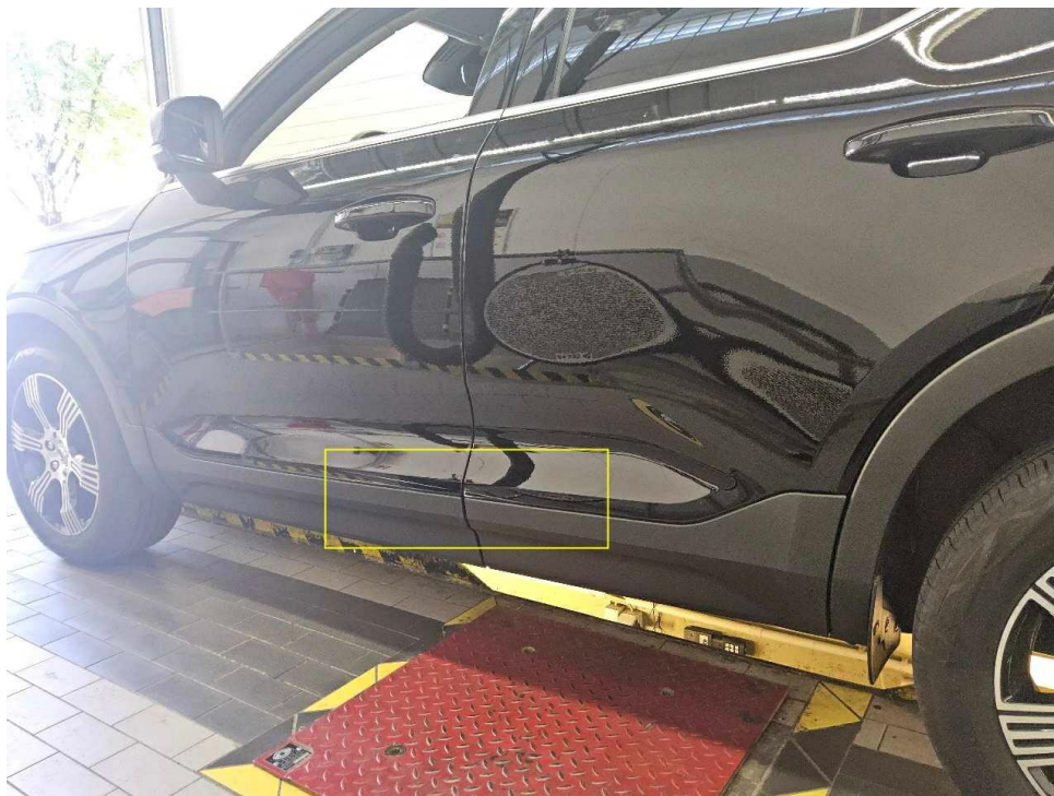
Bild 17 : Tür vorne links / Tür hinten links, eingedrückt
