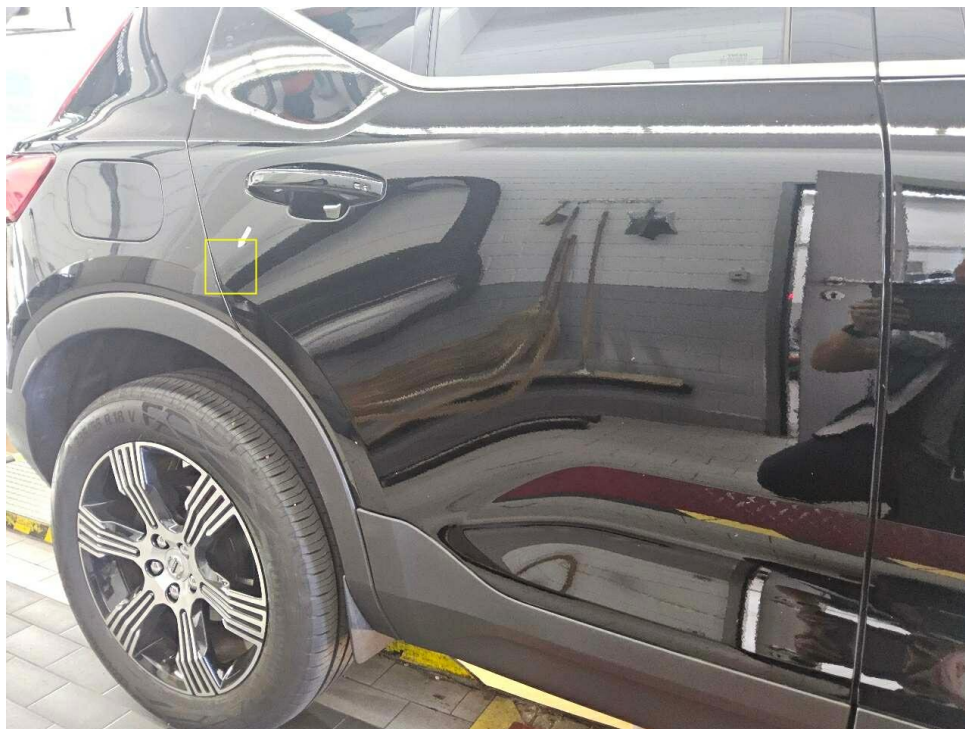
Bild 23 : Tür hinten rechts, zerkratzt (oberflächlich)
