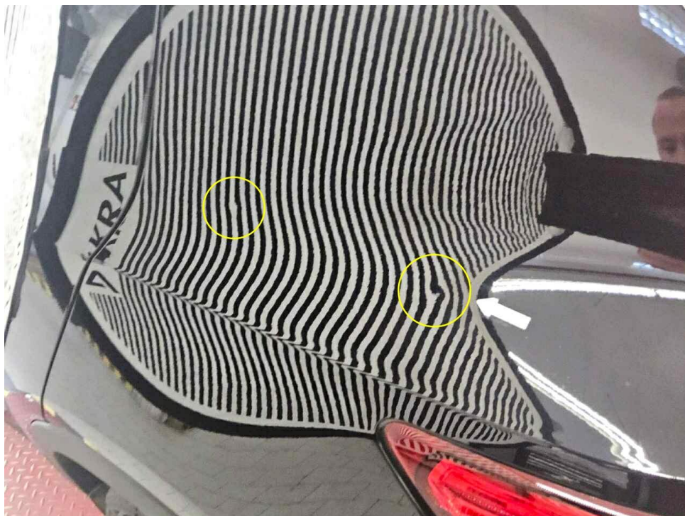
Bild 26 : Seitenteil hinten links, eingedellt
