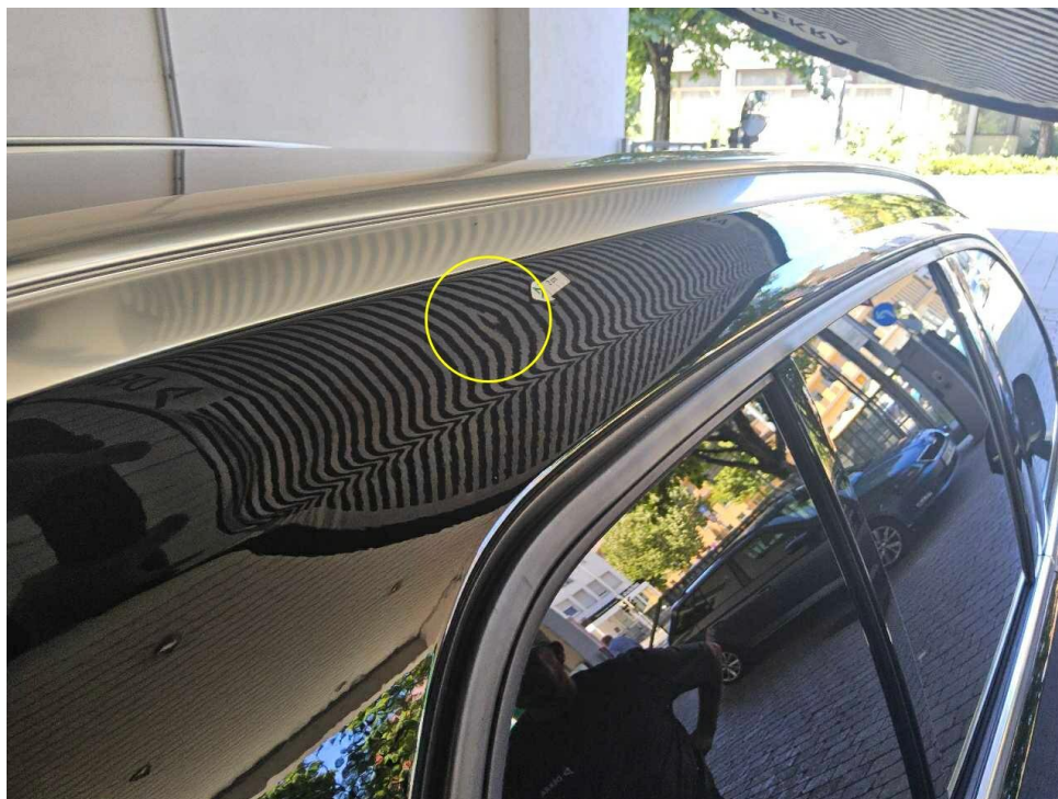
Bild 35 : Dachrahmen rechts, eingedellt
