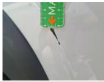
Door trim RR, Scratch(es), Replace
