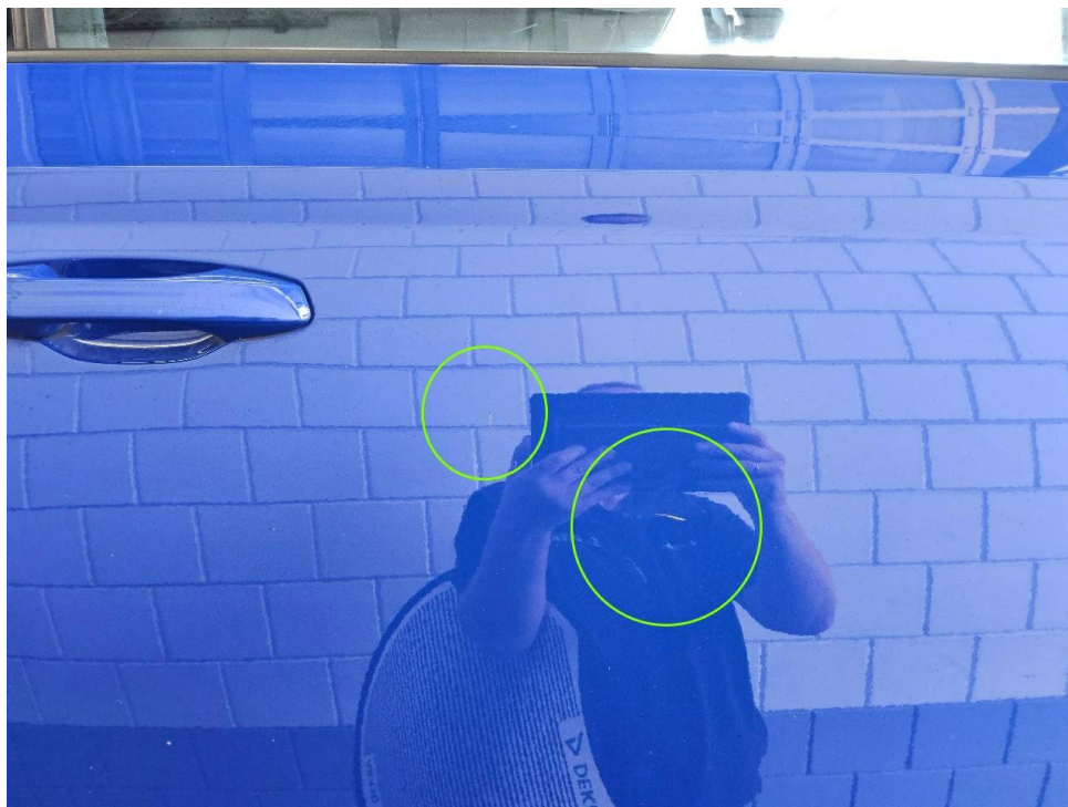
Bild 17 : Tür vorne rechts, Kratzer
