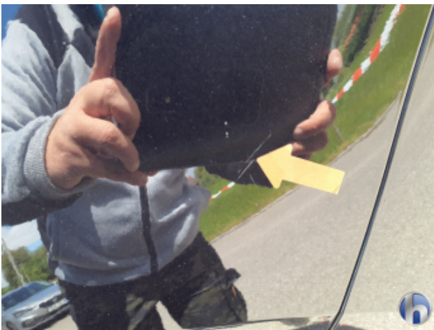
2. Seitenwand - Hinten - Links Kratzer - Smart Repair
