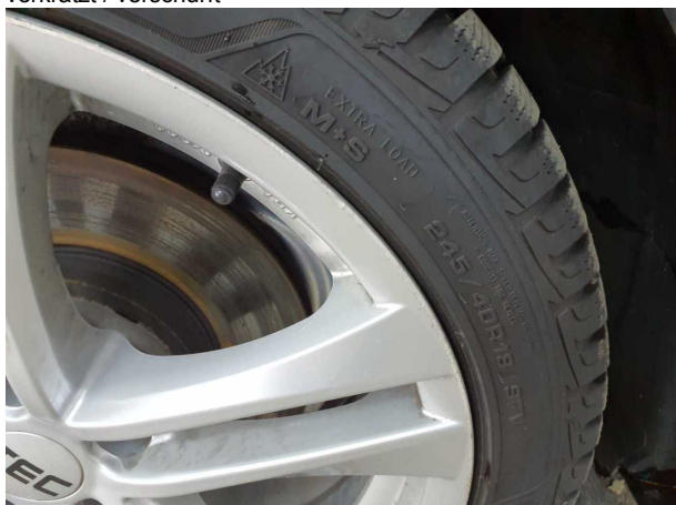
Beschädigung #1: Rad/Reifen: Leichtmetallfelge vorn rechts - verkratzt / verschürft
