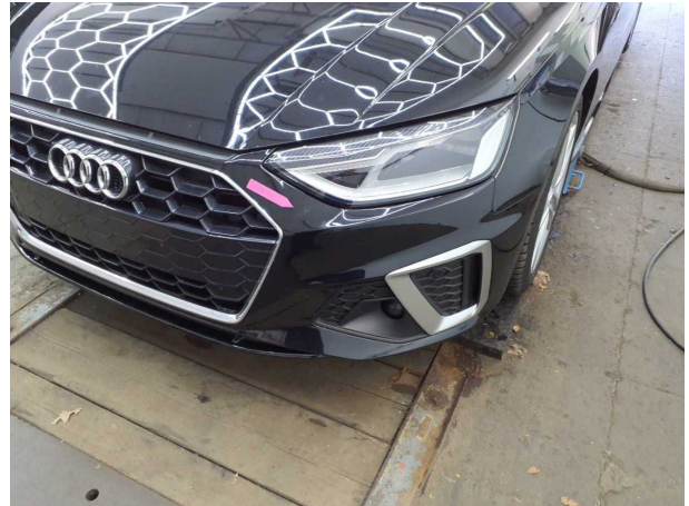
Beschädigung #3: Stossfänger vorn: Stossfänger vorn - Steinschlag - Smart Repair
