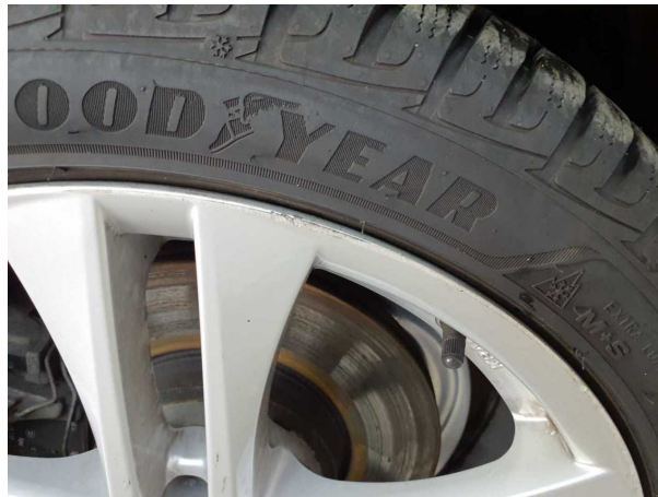
Beschädigung #1: Rad/Reifen: Leichtmetallfelge vorn rechts - verkratzt / verschürft
