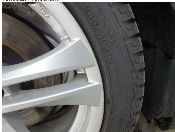
Beschädigung #1: Rad/Reifen: Leichtmetallfelge vorn rechts - verkratzt / verschürft
