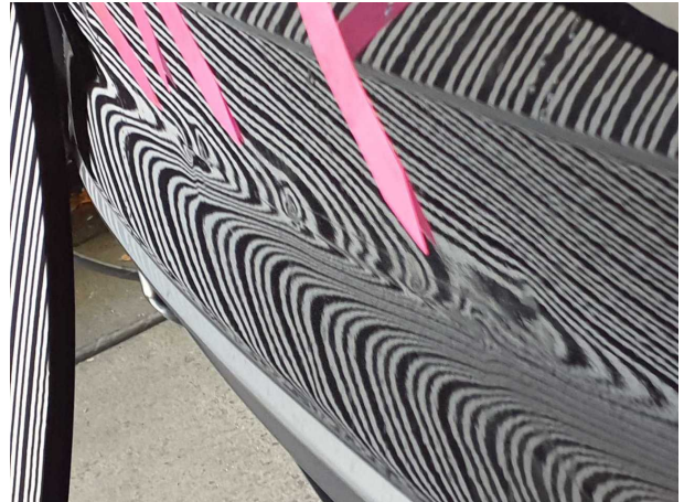
Beschädigung #4: Stossfänger hinten: Stossfänger hinten - beschädigt - instandsetzen und lackieren
