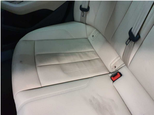
Beschädigung #2: Sitz hinten: Rücksitz - verschmutzt - reinigen
