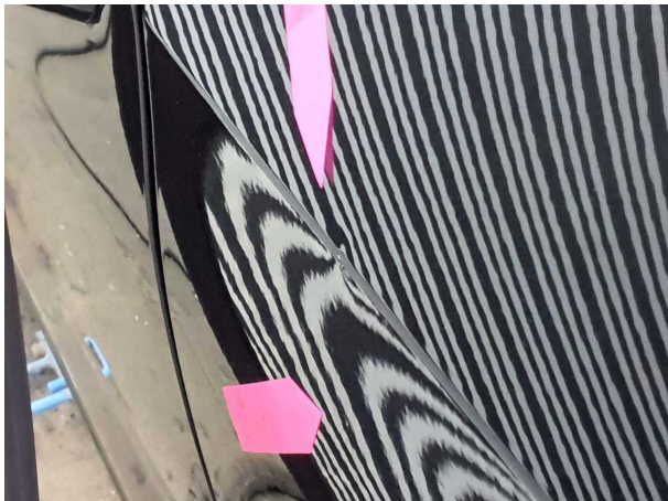
Beschädigung #6: Tür hinten links: Tür - Delle / Lackschaden - instandsetzen und lackieren
