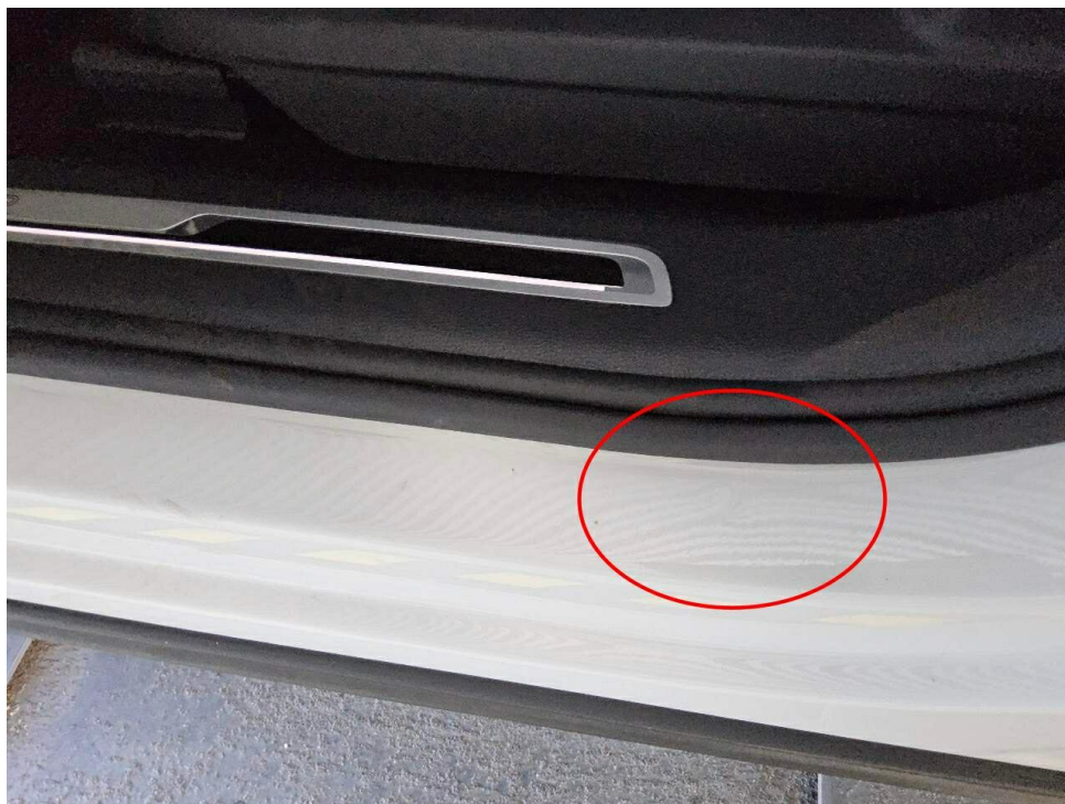
Bild 17 : Einstieg vorne links Delle
