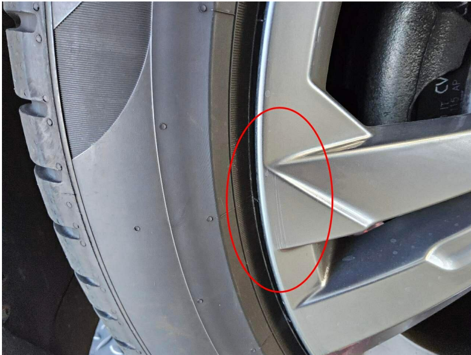
Bild 19 : Felge vorne links angeschrammt
