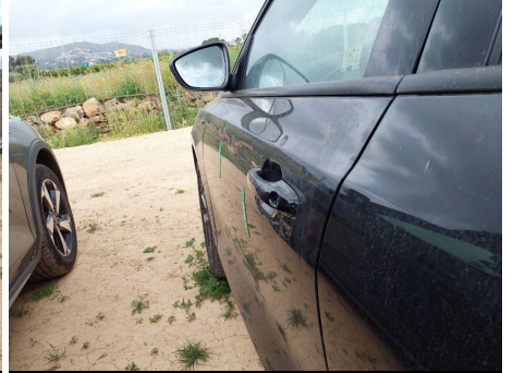
Puerta / Delantero Izquierdo / Abolladura
