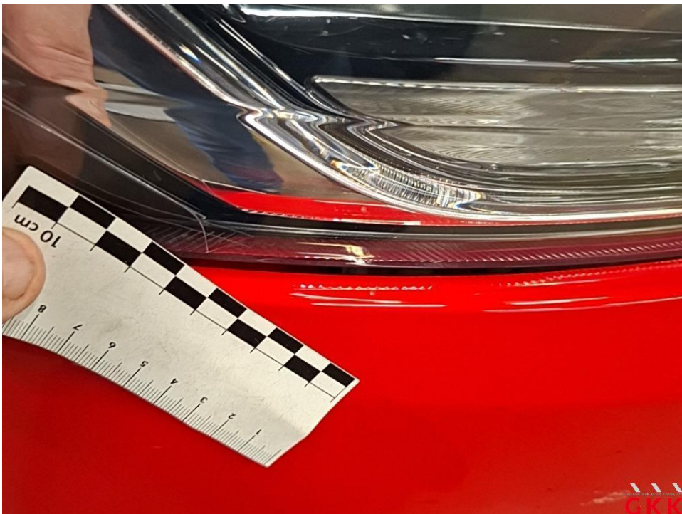
Bild 18 Stoßfänger vorne, Spaltmaß fehlerhaft, prüfen
