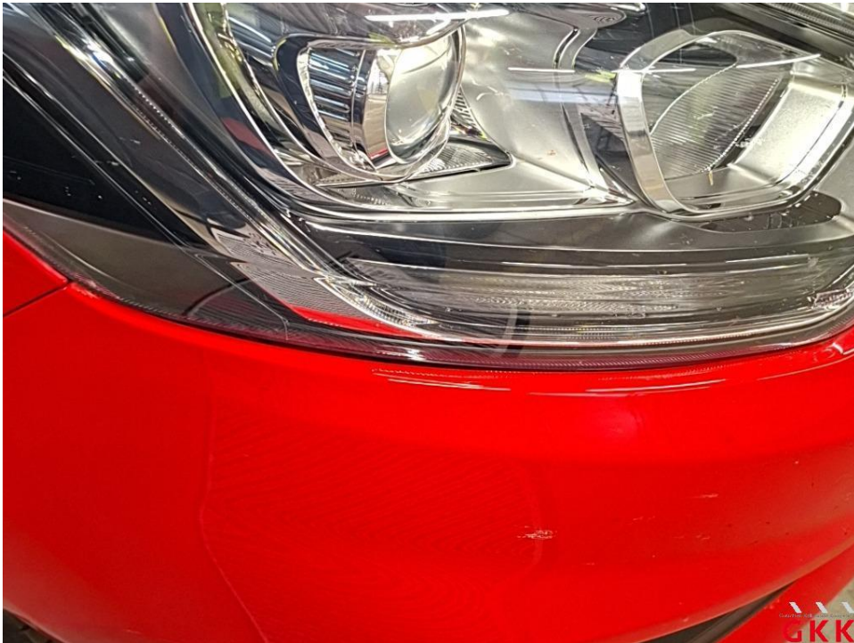
Bild 17 Stoßfänger vorne, Spaltmaß fehlerhaft, prüfen
