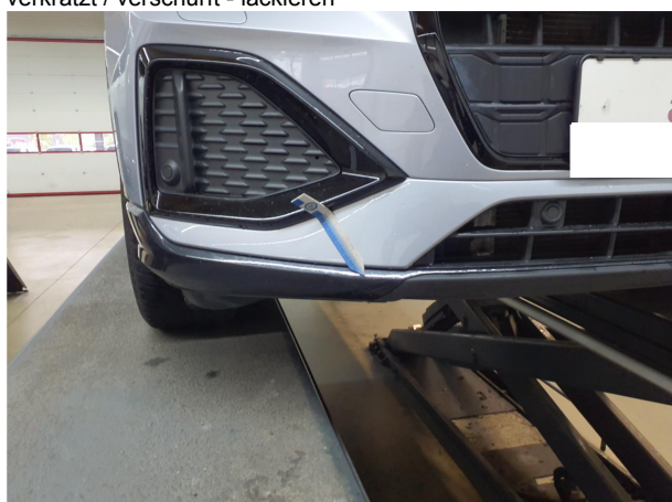
Beschädigung 3: Verkleidungen/Abdeckungen: Zierleiste / Dekorleiste (Stoßfänger vorne) - verkratzt / verschürft - lackieren
