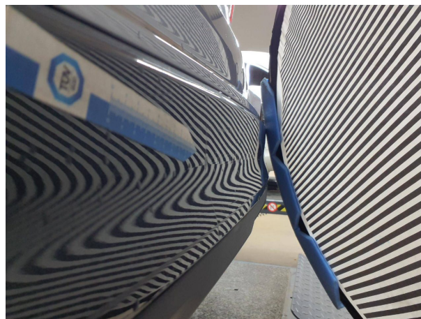
Beschädigung 4: Stossfänger hinten: Spoiler - verformt - instandsetzen und lackieren
