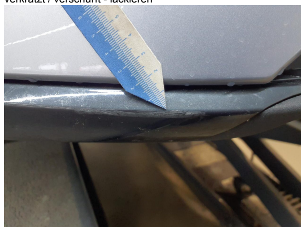
Beschädigung 3: Verkleidungen/Abdeckungen: Zierleiste / Dekorleiste (Stoßfänger vorne) - verkratzt / verschürft -
