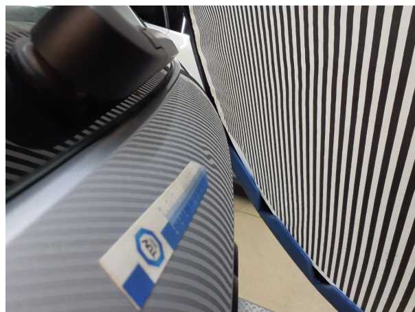
Beschädigung 1: Heckklappe/-tür: Heckklappe - Delle(n) - Smart Repair
