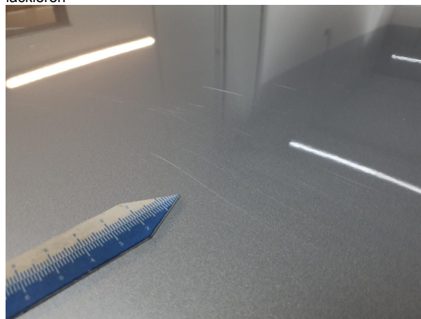
Beschädigung 6: Fahrzeugdach: Dach - verkratzt / verschürft... lackieren
