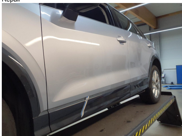
Beschädigung 2: Tür vorn links: Tür (Verkleidung unten) - verkratzt / verschürft - lackieren
