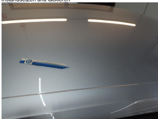
Beschädigung 6: Fahrzeugdach: Dach - verkratzt / verschürft - lackieren
