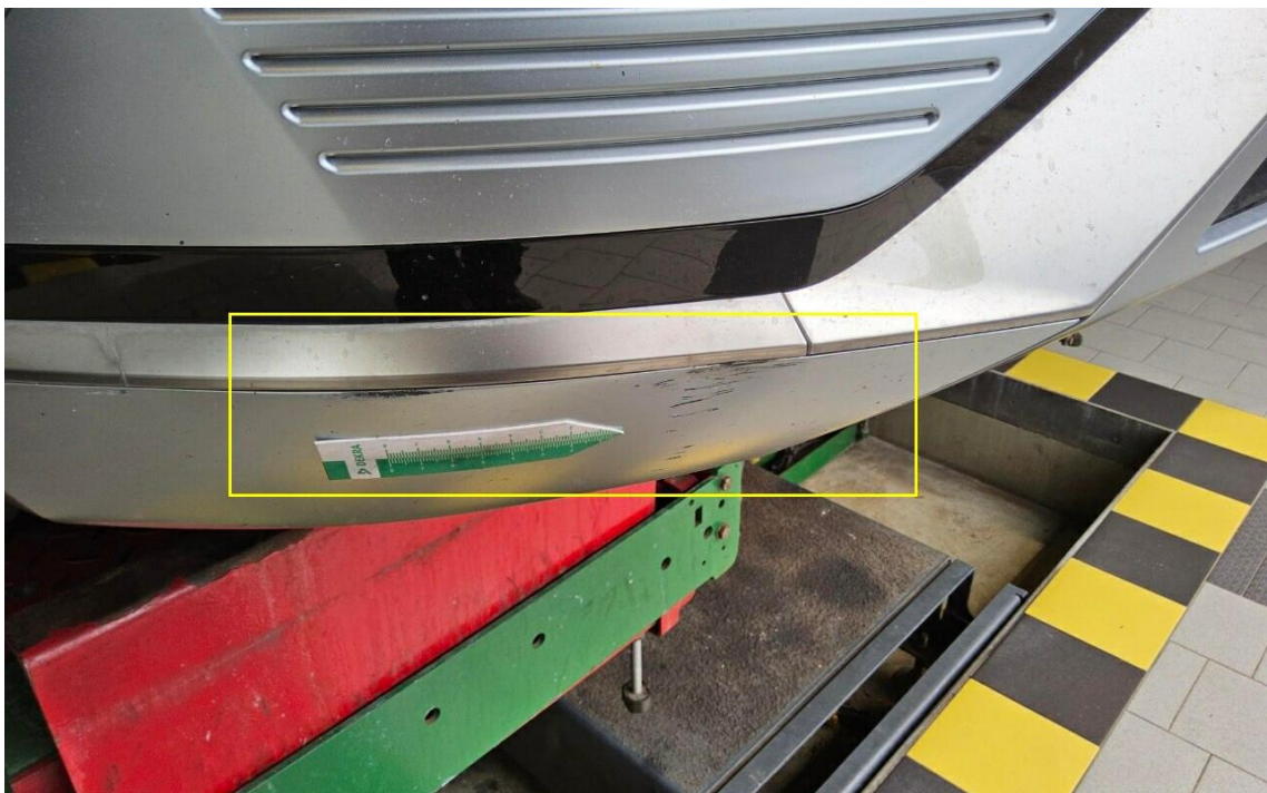
Bild 9 : Frontspoiler vorne rechts verschrammt und deformiert
