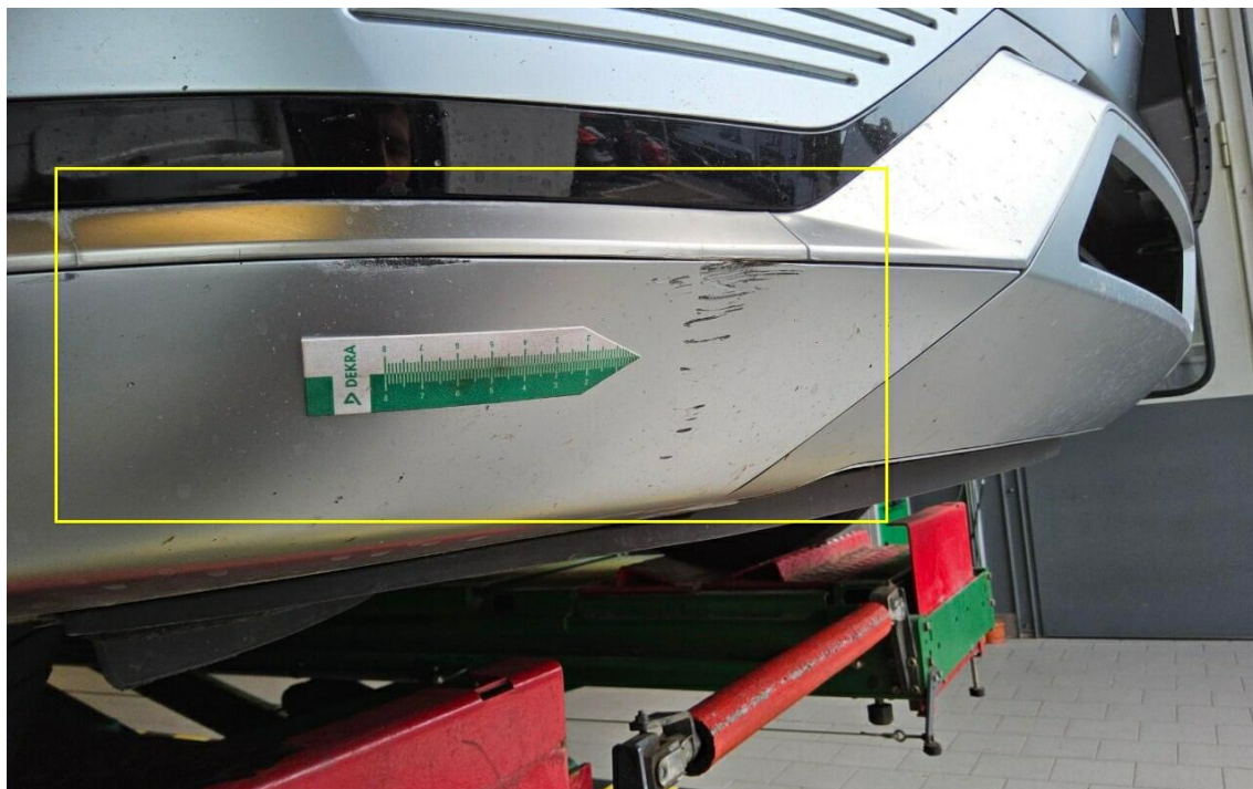
Bild 10 : Frontspoiler vorne rechts verschrammt und deformiert
