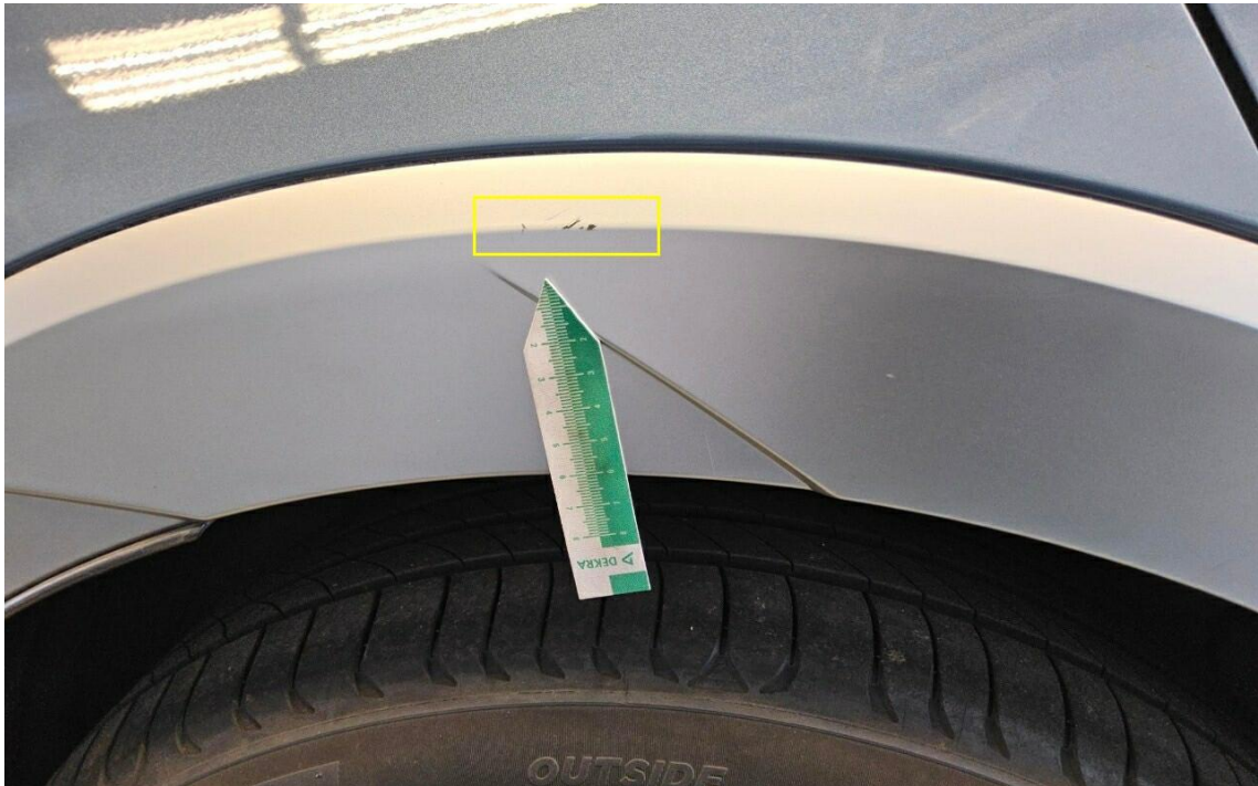
Bild 18 : Seitenteil hinten rechts Zierleiste Lackierung, zerkratzt, lackieren
