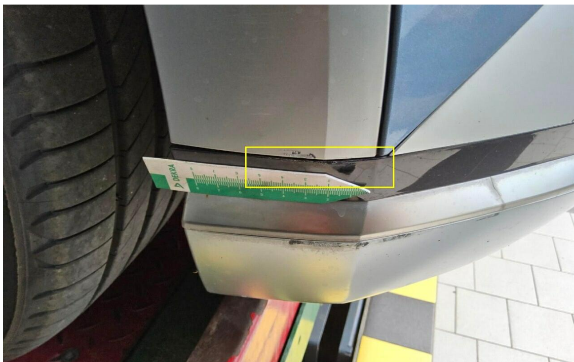
Bild 13 : Radlaufblende vorne rechts verschrammt
