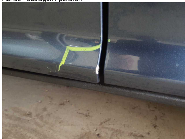
Beschädigung #2: Tür vorn links: Zierleiste unten - verkratzt / verschürft - Smart Repair
