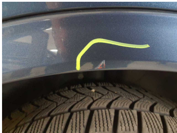
Beschädigung #1: Kotflügel rechts: Radhausverbreiterung - Abrieb - auslegen / polieren
