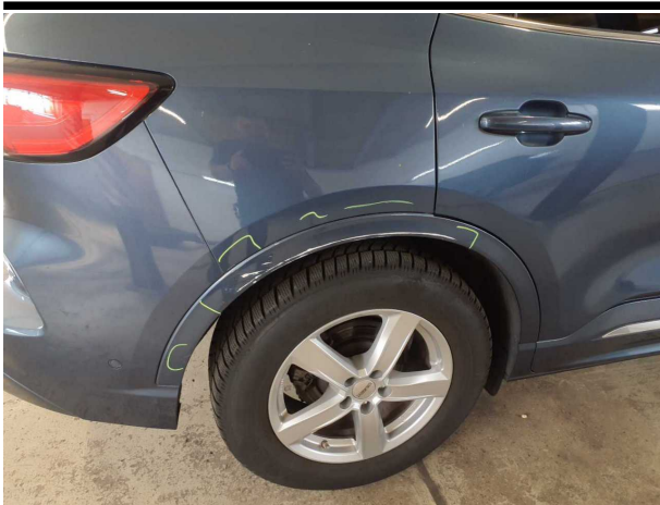
Beschädigung #7: Seitenwand rechts: Radhausverbreiterung - verkratzt / verschürft - Smart Repair
