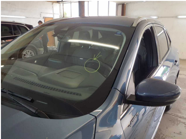
Damage #8: Vehicle glazing: Windscreen, heated (Mit Rissbildung) - Stone chips - Replace
