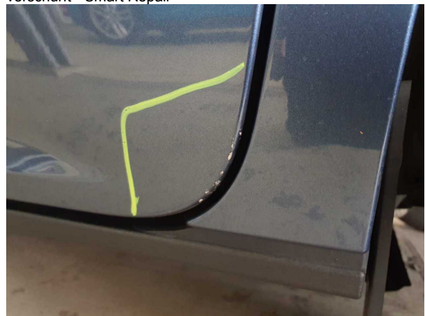
Beschädigung #6: Tür hinten links: Zierleiste unten - verkratzt / verschürft - Smart Repair
