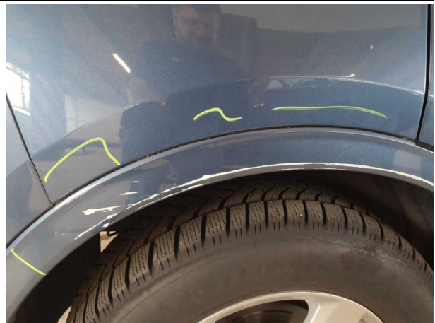
Beschädigung #7: Seitenwand rechts: Radhausverbreiterun... verkratzt / verschürft - Smart Repair
