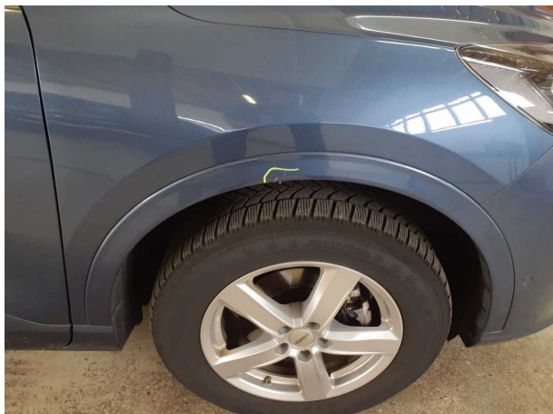
Beschädigung #1: Kotflügel rechts: Radhausverbreiterung - Abrieb - auslegen / polieren
