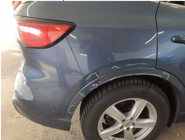
Beschädigung #5: Seitenwand rechts: Seitenwand - verkratzt / verschürft - Smart Repair
