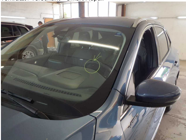
Beschädigung #8: Verglasung: Frontscheibe heizbar (Mit Rissbildung) - Steinschlag - erneuern
