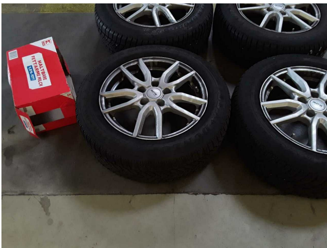
Damage 1: 2nd wheel set: 2 tyres (<4mm, gehören nicht zur Ausstattung) - does not meet manufacturer specifications - No deduction
