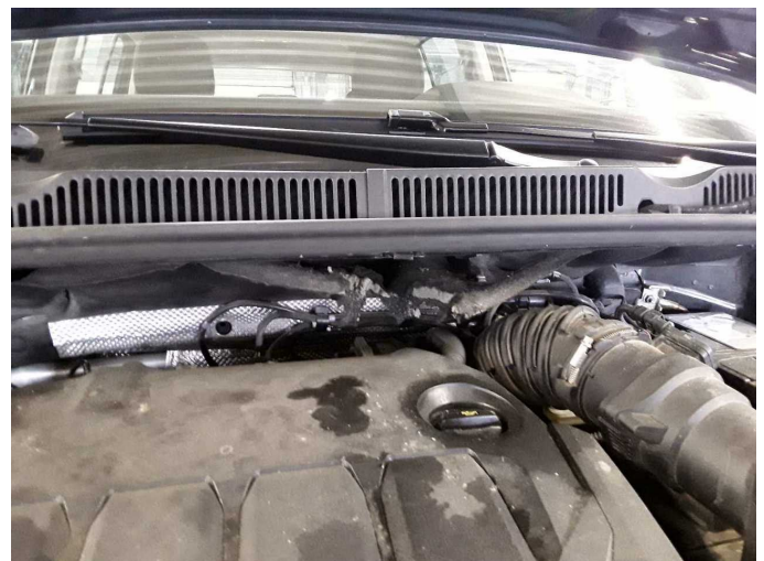
Damage 3: Body: Firewall trim (Dämpfung außen) - Damage caused by marten / rodent - Replace
