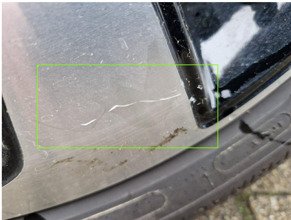
Bild 11 : Felge hinten rechts Kratzer
